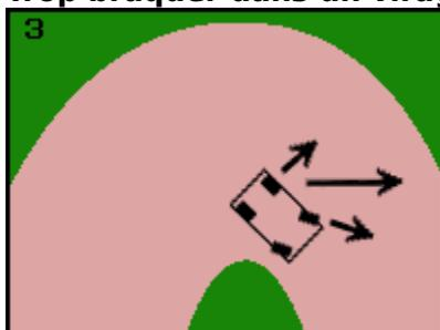
**Pour éviter cela, quand vos pneus arrière se mettent à glisser, tournez le volant dans la direction du tour: de cette façon, la force centrifuge se répartira entre les quatre pneus. (fig. 3)**
