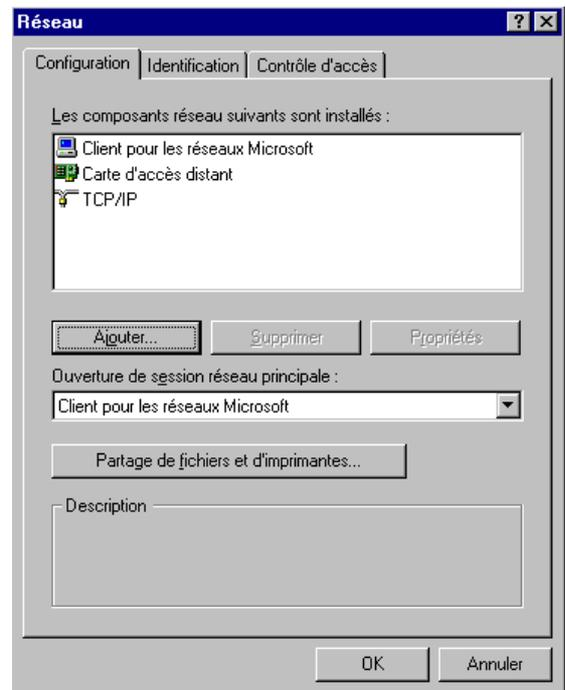
Si les 3 composants ci-dessus (client pour les réseaux Microsoft, carte d'accès distant, tcp/ip) sont installés, vous pouvez directement aller à la rubrique 3 (Configuration du protocole TCP/IP)
