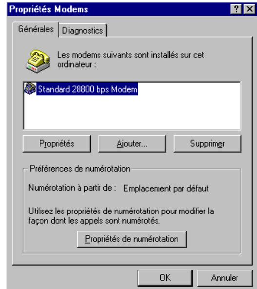
Quelle que soit la marque de votre modem, utilisez le MODEM STANDARD correspondant à la vitesse de votre modem : dans notre exemple, le modem standard 28800 est utilisé pour n'importe quel modem 28800. Le réglage modem standard est en effet généralement bien plus fiable que le pilote spécifique à votre modem. Pour installer ce modem, cliquez sur AJOUTER. La fenêtre suivante apparaît.
