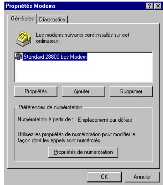
Le pilote (en anglais *driver*) du modem est maintenant installé. Il vous faut maintenant vérifier sa configuration. Pour cela cliquez sur le bouton PROPRIETES. La fenêtre suivante apparaît alors. Mettez la vitesse à 57600 dans l'onglet GENERAL, et ce quel que soit votre modem.
