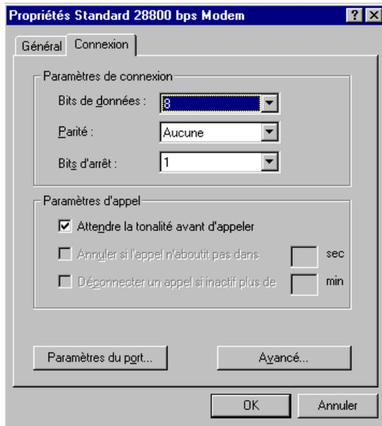
Votre configuration doit être rigoureusement identique à celle présentée ci-dessus (bit de données=8, parité=aucune, bit d'arrêt=1). Si c'est le cas, cliquez sur le bouton AVANCE.
