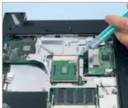
Finalisieren: Wärmeleitpaste hauchdünn (weniger ist mehr!) und gleichmäßig auf CPU und Grafichip auftragen – so wird die Hitze schnell über den Kühlkörper abgeleitet.
