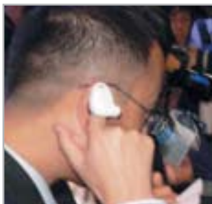
Finger im Ohr: „Yubi-Wa“ überträgt den Schall des Handy-Lautsprechers. Um zu hören, steckt man sich den Finger ins Ohr.
