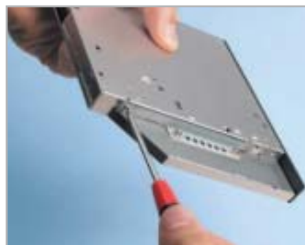
Schienenwechsel: Bei den Laufwerken müssen Führungsschienen und/oder Anschlussleiste getauscht werden. Allerdings passt die Frontblende in den seltensten Fällen.
