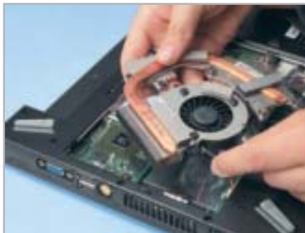
Kühlkörper-Demontage: Prozessor – und auch Grafikeinheit – verbergen sich unter der großen Kühleinheit, die als Erstes behutsam entfernt wird.
