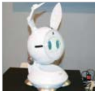
Schlauer Hase: Hitachis Entwurf einer universellen Fernbedienung versteht Sprache und kann den Videorecorder programmieren.
