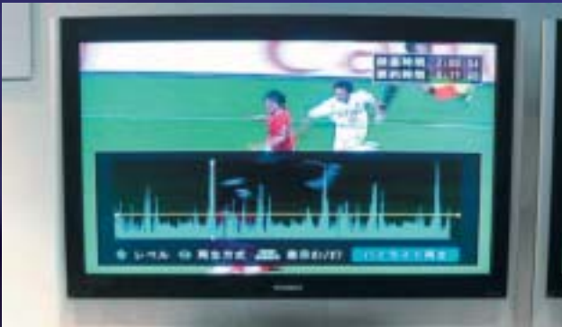
Automatische Zusammenfassung: Hitachis DVD-Recorder erkennt an der Geräuschkulisse spannende Sportszenen und zeichnet nur sie auf.
