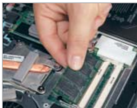
Doppelter Einsatz: Werden beide RAM-Bänke bestückt, steigt die Performance bei Dual-Channel-Systemen deutlich an. Wichtig: Die Module müssen absolut identisch sein.
