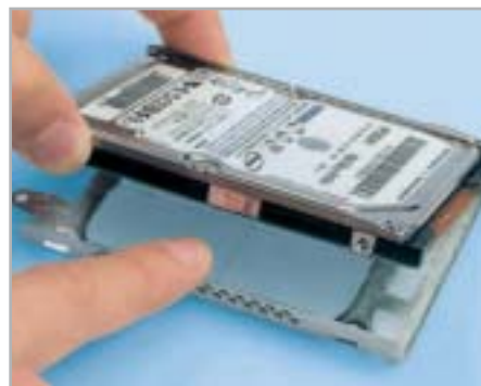
Käfighaltung: Zum besseren Schutz sitzt die Platte häufig im Käfig. Bei älteren IDE-Modellen ist oft noch ein Adapter zu wechseln. S-ATA-Platten erkennen Sie am schmalen Stecker.
