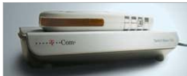
Geldmaschine: Sobald ein Handy auf der Switch Base liegt, wählt diese eine Servicenummer und leitet alle Mobilgespräche aufs Festnetz um.
