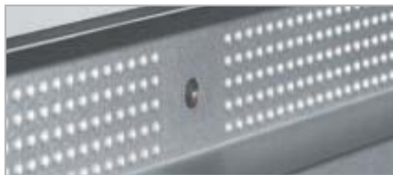
Augenfreundlich: Ein Sensor in der Front misst beim 17-Zoll-Testsieger von Eizo das Umgebungslicht und optimiert die Helligkeit des Displays automatisch.
