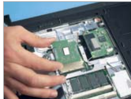
CPU-Tausch: Beim Einsetzen müssen die Pfeile auf der CPU-Oberseite und am Sockel übereinander liegen – sonst verbiegen sich die Pins und machen den Chip unbrauchbar.
