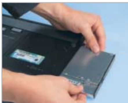
Rauszieher: Meist sind nur ein bis zwei Schrauben an der Unterseite zu lösen, um das Notebook-Laufwerk – in diesem Fall seitlich montiert – herauszuziehen.
