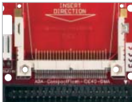
Flash als Festplatte: Der Adapter von ES&S macht aus der CompactFlash-Karte eine „Festplatte“.
