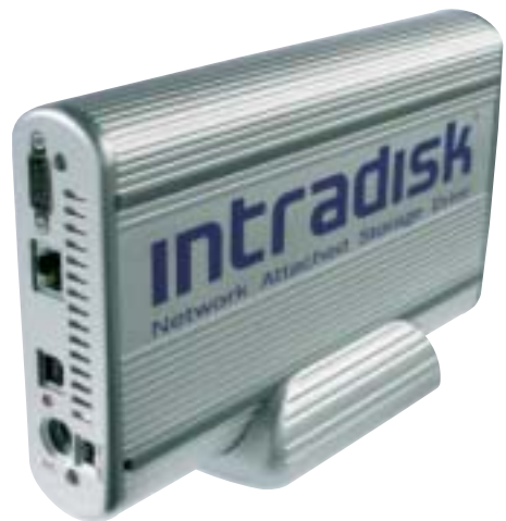
Mehr als nur Multimedia: Auf dem XScale-Prozessor im Intradisk Server läuft ein vollständiges Linux – neben UPnP lassen sich deshalb auch viele andere Serverdienste installieren.
