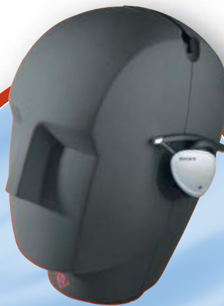
Herr Neumann: Mit dem Kunstkopf K 100 (ca. 6.000 Euro) der Firma Neumann testet CHIP die Kopfhörer.
