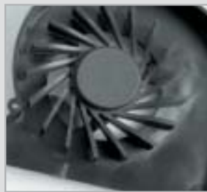
Tuchföhlung: Das beschädigte Lager lässt den Lüfter lautstark am Gehäuse schleifen.
