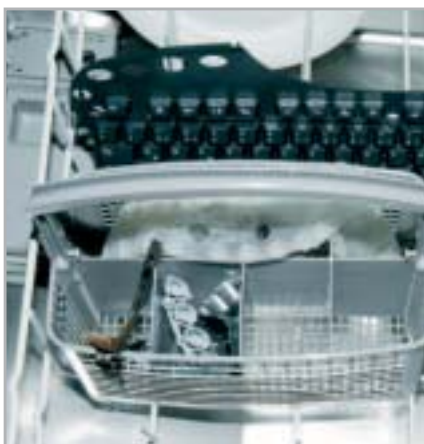
24 Spülmaschinenfest: Plastik- und Silikonteile der Tastatur können Sie bis 40° C im Geschirrspüler reinigen.
