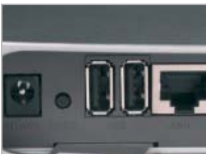
Volle USB-Anbindung: Mit dem Asus WL-500g Deluxe können Sie Drucker und/oder Festplatte ins Netzwerk bringen.
