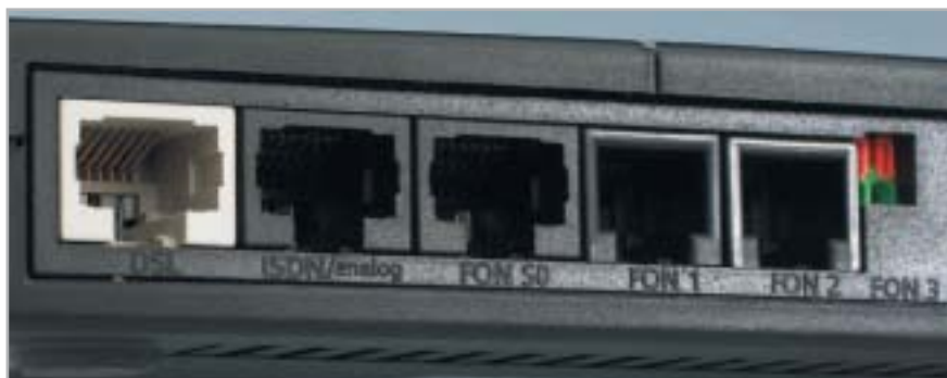
Telefonanlage: An die FritzBox Fon WLAN 7050 von AVM können Sie analoge Telefone direkt anschließen – oder dank des vorhandenen S 0 -Busses gleich eine ganze ISDN-Anlage. Hier übernimmt der W-LAN-Router die gesamte Hauskommunikation.
