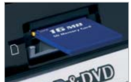
Panasonic DMR-EH 52: Dieser Recorder verfügt über einen SD-Kartenleser für Diashows direkt aus der Digitalkamera.
