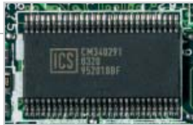
Taktgeber: Ein „Clock-generator“ wird vom Tuning-Tool beschleunigt.
