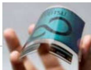
Flexibel und sparsam: Das biegsame LCD von Fujitsu kann einzelne Bilder dauerhaft ohne Strom anzeigen.
