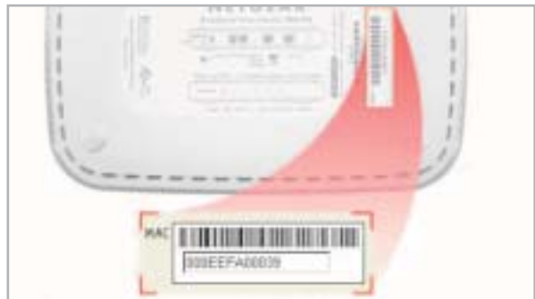
Simpel: Für die korrekte Konfiguration des Netgear TA612V brauchen Sie auf der Sipgate-Website nur die MAC-Adresse Ihres Gerätes einzutragen – schon ist alles Nötige erledigt.
