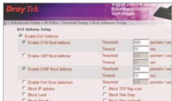
Profi-Schutz: Die Einstellungen der DrayTek-Firewall (Vigor 2900VGi) lassen keine Wünsche offen. Profis können hier einfach alles konfigurieren.
