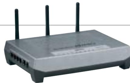
**Buffalo WZR-G108:** Altbekannte Bauform, neue Technik – der MIMO-Router von Buffalo zeigt statt zwei nunmehr drei Antennen. Per AOSS (AirStation OneTouch Secure System) konfiguriert sich der Router selbstständig.
