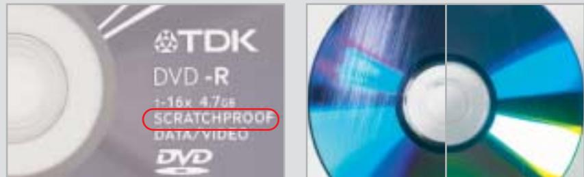
**Extra hart:** TDK rüstet einen Teil seiner Rohlinge mit ScratchProof-Beschichtung aus. Die beiden Scheiben im rechten Bild haben wir mit Küchenstahlwolle bearbeitet – auf dem linken Rohling (ohne Beschichtung) sind deutliche Kratzer zu erkennen.
