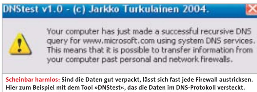
**Scheinbar harmlos:** Sind die Daten gut verpackt, lässt sich fast jede Firewall austricksen. Hier zum Beispiel mit dem Tool »DNStest«, das die Daten im DNS-Protokoll versteckt.
