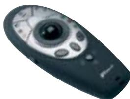
■ **Präsentationssteuerung** Dank Trackball, Laserpointer und gut angeordneten Funktionstasten ist der Wireless Multimedia Presenter mit einer Hand steuerbar.
