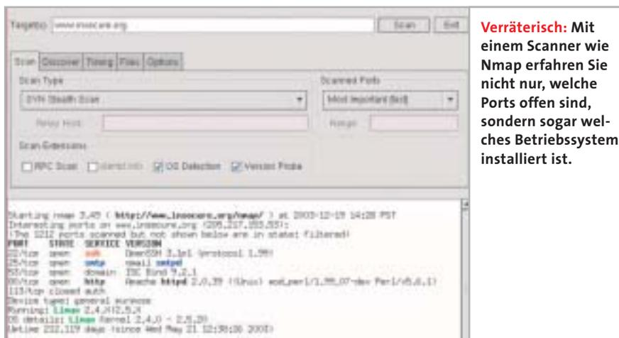
**Verräterisch:** Mit einem Scanner wie Nmap erfahren Sie nicht nur, welche Ports offen sind, sondern sogar welches Betriebssystem installiert ist.
