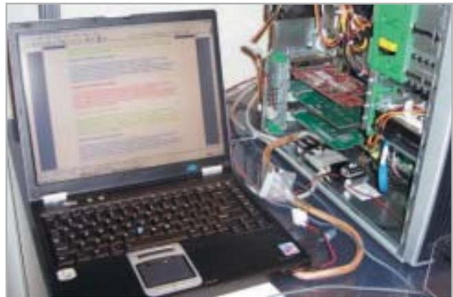
**Demonstration:** Samsung zeigte auf der WinHEC, wie Festplatten mit zusätzlichem NV-Flash-Speicher funktionieren werden.
