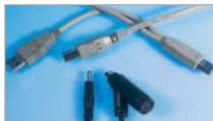
**Stromversorgung:** Für 2,5-Zoll-Festplatten ist ein Y-USB-Kabel (oben) oder ein PS2-Adapter (unten) unbedingt erforderlich.
