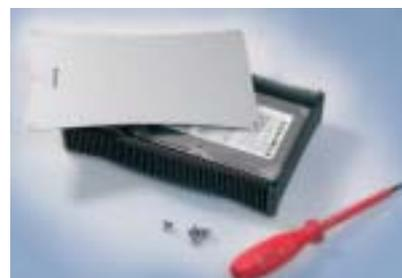
**2. Schritt:** Nach dem Anschluss des Daten- und Stromkabels ist das Chassis fast einsatzbereit – Deckel drauf, fertig.
