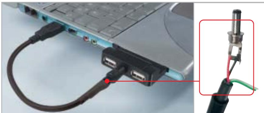
22 Aufgebohrt: Eine PC-Card verhilft älteren Notebooks zu USB 2.0. Die selbst gelötete Spannungsversorgung spart unterwegs ein Netzteil. Rechts die Kontaktbelegung.
