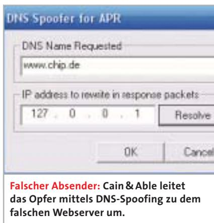
**Falscher Absender:** Cain & Able leitet das Opfer mittels DNS-Spoofing zu dem falschen Webserver um.
