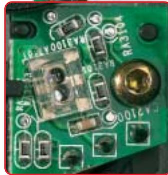
**Steuereinheit:** Diese Platine ist für die Steuerung des Lasers beim „Bedrucken“ zuständig. Zudem kommuniziert sie mit dem PC. Das optische Element liest den Barcode und bestimmt die Rohlingsposition.
