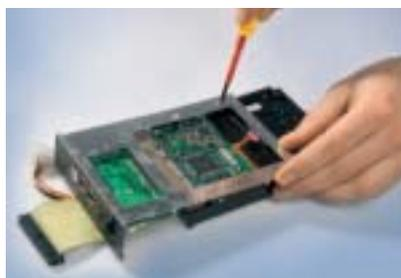
**1. Schritt:** Das externe 3,5-Zoll-Gehäuse ist bereits geöffnet, die Festplatte der Wahl wird auf das Chassis geschraubt.
