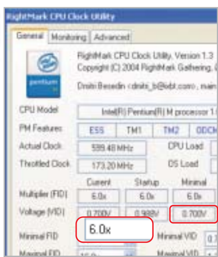
2. Pentium-M-Tuning: Stellen Sie für mehr Akku-Power »Minimal« ein.
