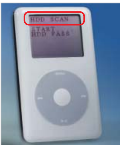
24 iPod: Mit dem versteckten Tool HDD Scan prüfen Sie, ob die Festplatte noch tadellos funktioniert.
