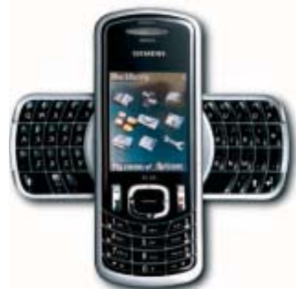
Kreuzweise: Die drehbare, vollständige QWERT-Tastatur des Siemens-Smartphones SK65 erleichtert die Handhabung der integrierten Blackberry-Funktion erheblich.
