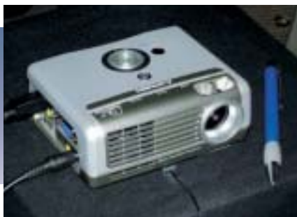
Mini-Projektor: Mitsubishi zeigte einen der ersten Mini-Beamer mit DLP-Technik; er ist kaum größer als ein Zigarettenetui.
