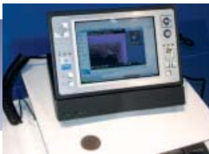
Kleinster PC der Welt: Der „ultraportable“ Sony Vaio VGN U-750P sieht aus wie ein PDA – ist aber ein vollwertiger Windows-XP-PC.
