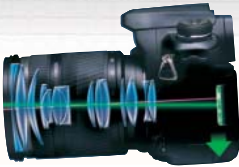
Bildstabilisator: Minolta bewegt statt der Linsen den Bildsensor – so bleiben Objektiv günstig.
