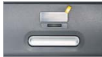
Knopfdruck: Mittels Taster können Sie beim Canon Pixma iP3000 eines von zwei Papierfächern für den Ausdruck wählen.
