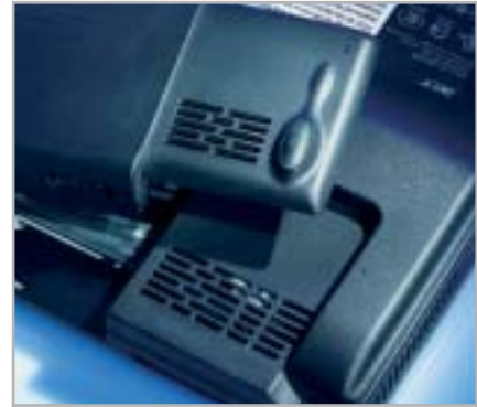
Wärmestau: Der knapp bemessene Abluftschacht des Acer wird durch den Akku noch reduziert. Hier droht Überhitzung.
