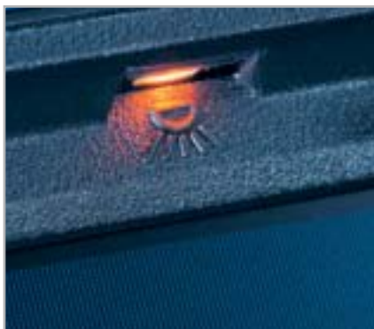
Spot an: Das IBM verfügt als einziges Subnotebook über eine in den Deckel integrierte Tastaturbeleuchtung.
