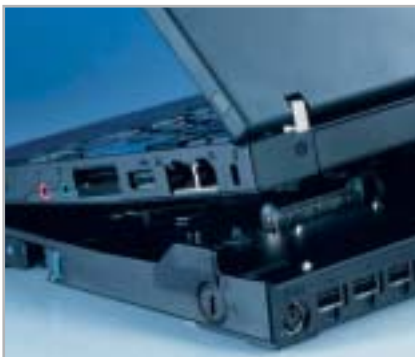
Angedockt: Die optionale Docking-Station verhilft dem IBM zu vielen Schnittstellen und einem optischen Laufwerk.
