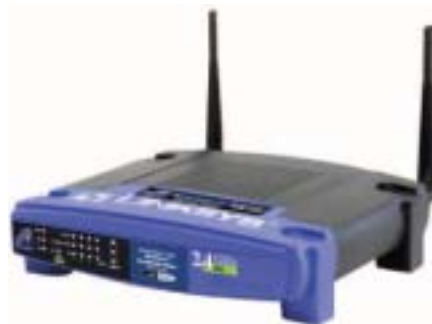
Linksys WRT54G: Nach dem Update arbeiten die beiden Antennen separat – und steigern so den Datendurchsatz spürbar.
