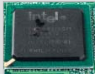
Stresspustel: Der kleine Pickel auf der Chipoberfläche zeugt von Überstrom.
