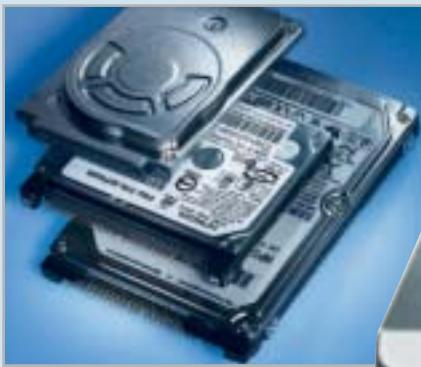
Mini-Komponenten: In Subnotebooks drehen sich statt 2,5-Zoll-Drives (unten) oft 1,8-Zöller: mittig Hitachi, oben Toshiba.
