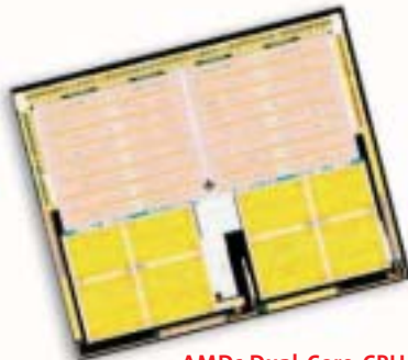
AMDs Dual-Core-CPU (Vergrößerung): Zwei Kerne für „drastisch“ mehr Leistung.
