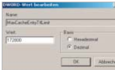
Höhere Halbwertszeit: Mit dem Wert »172800« bleiben DNS-Anfragen zwei Tage lang im DNS-Cache gespeichert.
