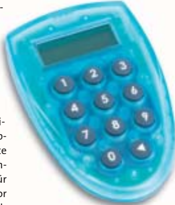
Passwort-Generator: Aus Uhrzeit und einer PIN errechnet das Gerät eine zeitlimitierte TAN.
