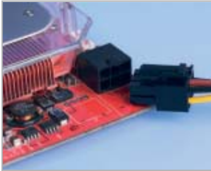
Energie: Auch PEG-Highend-Karten hängen trotz 75-Watt-Versorgung über den Slot an der Nabelschnur des Netzteils.
