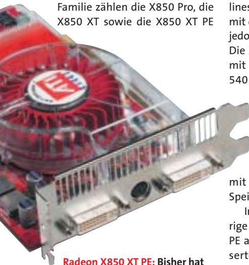
Radeon X850 XT PE: Bisher hat ATI gern über das Dual-Slot-Design von Nvidia gelästert – jetzt benötigt der Hersteller für sein Top-Modell ebenfalls den Platz zweier Slots.
