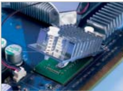
Dolmetscher: Nvidias HSI-Chip (High Speed Interconnect) trimmt AGP-Karten auf PCI-Express, wie hier eine GeForce PCX 5900.
