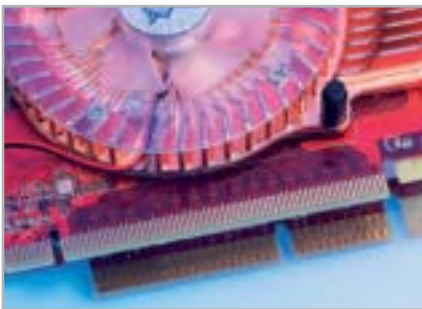
Kontaktfreudig: 164 Pins bietet eine PEG-3D-Karte (oben), Karten mit AGP 8x (unten) kommen mit 108 Kontakten aus.
