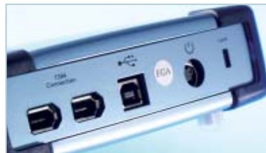
Externí disky používají rozhraní USB 2.0 a FireWire.
