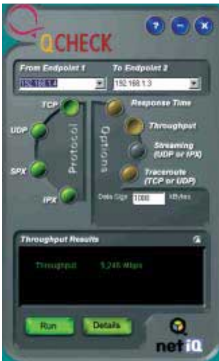
Pro testy jsme použili program QCHECK firmy NetIQ, který měří přenosovou rychlost a reakční dobu. U zařízení 802.11b můžete počítat s přenosovou rychlostí okolo 5 Mb/s a u 802.11g se zhruba 16 Mb/s.
