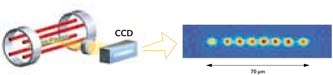
Obr. 1. V levé části obrázku je schéma lineární pasti používané na univerzitě v Innsbrucku. V ose pasti jsou drženy laserově vychlazené ionty. Vpravo je osmice iontů zviditelněná speciálním zobrazovacím zařízením. (Podle internetové prezentace R. Blatta, Universität Innsbruck, Institut für Experimentalphysik, http://online.itp.ucsb.edu/online/qinfo_co1/blatt/ )
