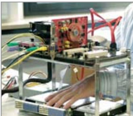
▲ Тестовый стенд: здесь побывал каждый из испытуемых CPU
