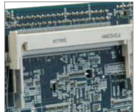
▲ Почти лэптоп: некоторые платы Eria могут работать с модулями памяти SODIMM для ноутбуков
