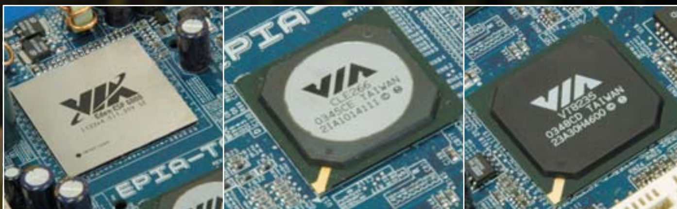
▲ Трое из Eria-TC: процессор Eden, северный мост CLE266 и южный VT8235
