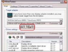
Утилита RivaTuner позволяет подключить дополнительные конвейеры в GeForce 6800
