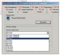
Установите частоту обновления для ЖК-монитора в пределах от 60 до 75 Гц
