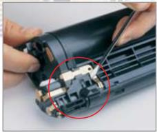
5 Крышечка картриджа Minolta-QMS 2300DL подходит к картриджу Epson C900
