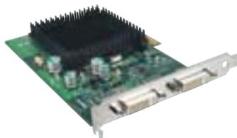
▲ «Трехголовый зверь»: Matrox Millennium P650 за \$190 поддерживает три монитора с примерно одинаковым качеством изображения на каждом
