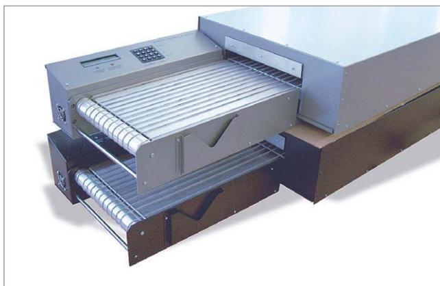
◀ Установка «S.M.D. – Трасса-5640» для пайки печатных узлов, выполненная по технологии на поверхности
