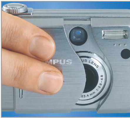
▲ Olympus C-50 Zoom: объектив этой камеры закрывается одним движением руки
