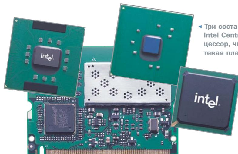
◀ Три составные части Intel Centrino — процессор, чипсет и сетевая плата
