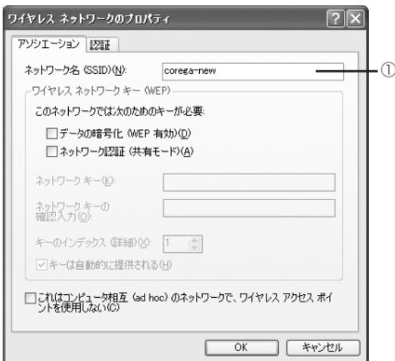
①「ネットワーク名(SSID)」欄に通信相手の機器に設定されているSSIDと同じ文字列を入力します。
