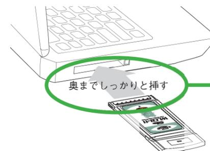
**STEP 2** 本製品をパソコンのPC カードスロットに奥までしっかり挿し込みます。
