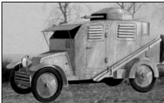
Der vollgepanzerte Charron-Panzerspähwagen wurde 1904 in Frankreich entwickelt. Er war mit einem Maschinengewehr ausgerüstet, konnte aber trotz den beiden u-förmigen Stahlträgern, die an der Seite befestigt waren und im Bedarfsfall unter die Räder gelegt werden konnten, keine größeren Hindernisse überwinden. Er war jedoch wesentlich schneller als die später kommenden Kettenfahrzeuge. Als Aufklärer hat er den Alliierten gute Dienste geleistet.
