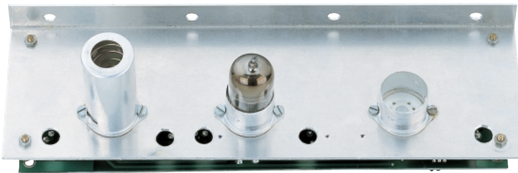
Fig.19 Sul telaio ad L andranno fissati con viti e dadi gli “anelli” di supporto che serviranno per innestare gli schermi cilindrici da porre sopra le valvole. Senza questi schermi le valvole potrebbero facilmente captare del ronzio di alternata.
