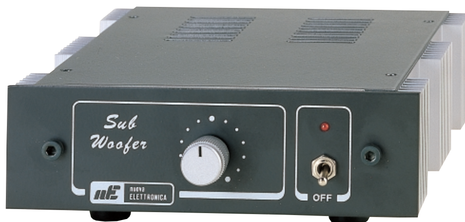
Fig.1 Il mobile studiato per il circuito Sub-Woofer è stato costruito con materiali di ottima qualità sottoposti ad una accurata lavorazione: i laterali sono stati realizzati con due alette di raffreddamento ossidate, l'interno è in lamiera zincata oro ed il pannello frontale è in alluminio verniciato a fuoco ed è completo di foratura e serigrafia.
