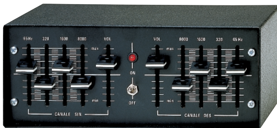
Fig.9 Foto del mobile metallico appositamente realizzato per l'equalizzatore grafico per auto. Dei dieci potenziometri presenti, due regolano il Volume sui rispettivi canali e gli altri otto vi permettono di regolare tutta la gamma di frequenze da 30 a 20.000 Hz.
