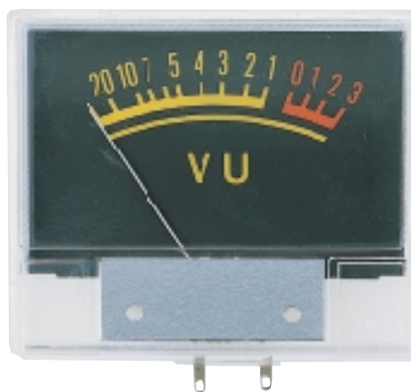
Fig.22 Anche se disegnato in modo diverso, lo strumentino Vu-Meter ha sempre un riferimento a 0 dB che non si dovrebbe mai superare per evitare distorsioni.
