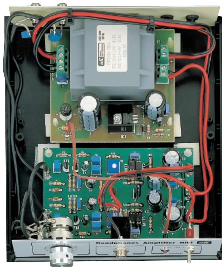
Fig.11 Sul piano del mobile fissate vicino al pannello frontale il circuito dell'amplificatore utilizzando i distanziatori plastici e vicino al pannello posteriore il circuito dello stadio di alimentazione.
