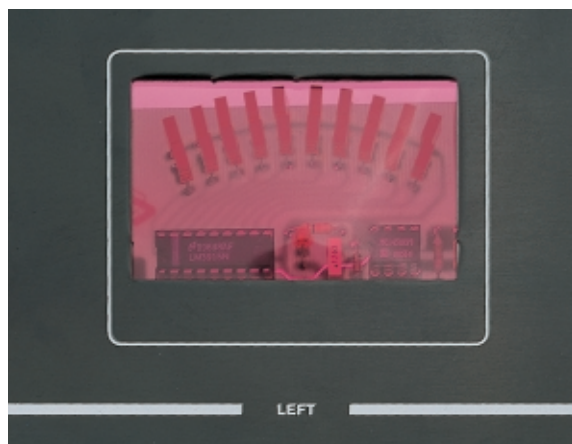
Fig.1 Se sul pannello frontale del mobile esiste già una finestra rettangolare sulla quale fissare uno strumentino a lancetta, dovrete incollare sul retro un ritaglio di plexiglas di colore rosso scuro in modo che frontalmente si vedano i soli diodi led accesi.
