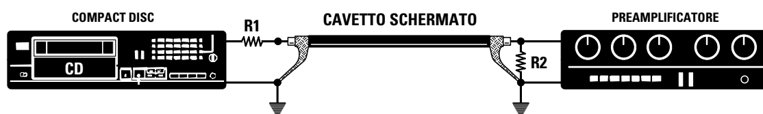
Fig.1 Qualsiasi sorgente, quale potrebbe essere un Registratore, un Pick-up, un CD ecc., dispone di una "impedenza" d'uscita (indicata con R1). Poiché anche l'ingresso del Preamplificatore dispone di una sua "impedenza" (indicata con R2), collegando una Sorgente ad un Preamplificatore si ottiene un circuito equivalente a quello di fig.2.
