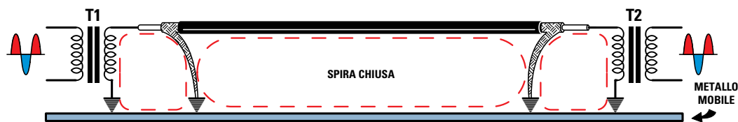
Fig.3 Se colleghiamo le due estremità della calza di schermo su punti di massa molto distanti tra loro, si formeranno delle invisibili "spire" capaci di captare del ronzio.
