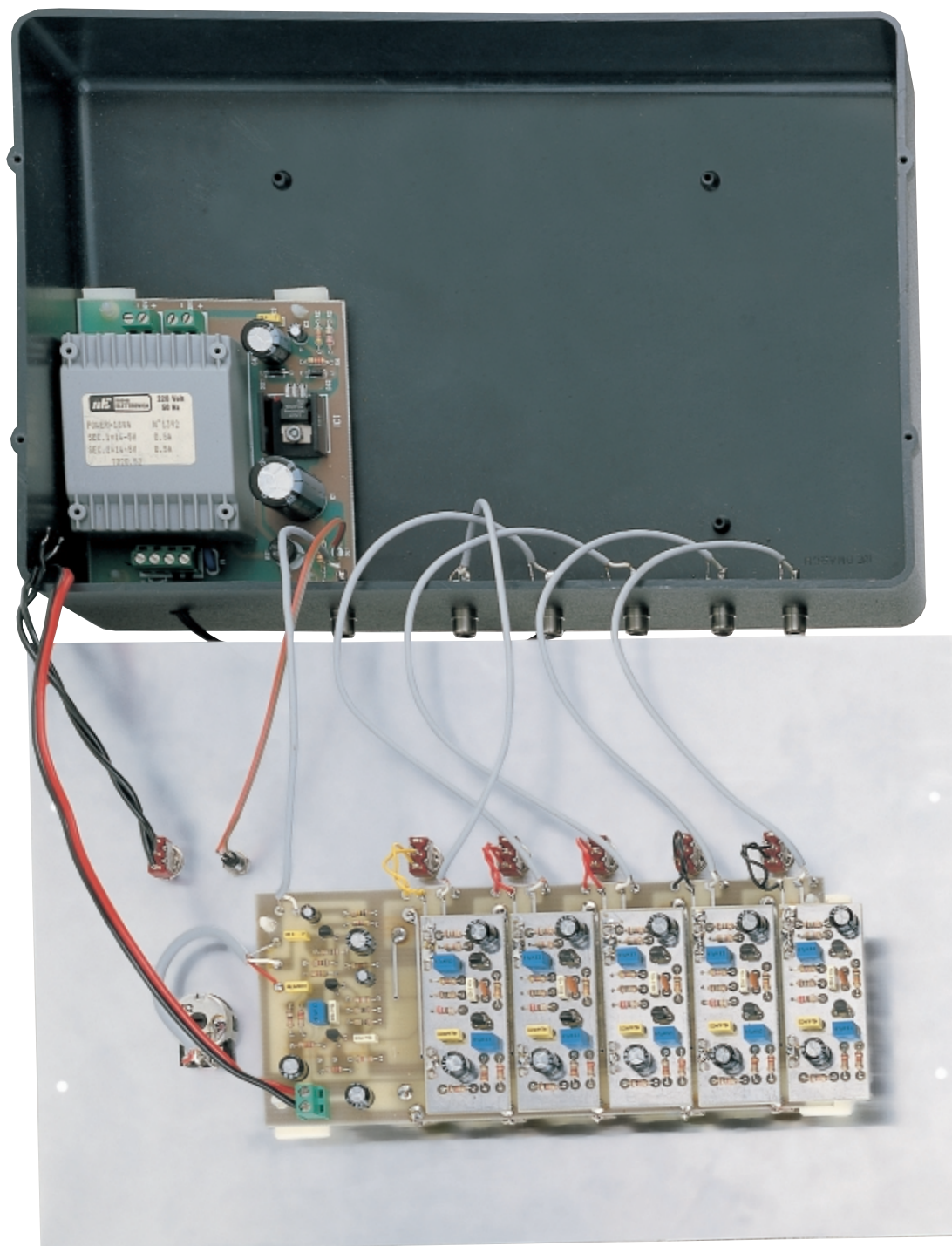
Fig.8 Il circuito stampato base LX.1241 andrà fissato sul pannello di alluminio del mobile a consolle utilizzando i quattro distanziatori plastici con base autoadesiva che troverete nel kit. Lo stadio di alimentazione LX.1145 va invece fissato all'interno del mobile plastico con altri quattro distanziatori plastici con base autoadesiva. Se avvicinando la mano al pannello frontale sentite del ronzio, lo potete eliminare collegando con un filo il metallo del pannello alla massa del circuito stampato.
