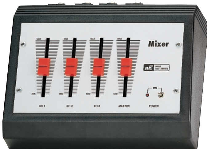
Fig.1 Come si presenterà a montaggio ultimato il Mixer Stereo a 3 canali. Come potete vedere in fig.8, sul circuito stampato di questo Mixer abbiamo collocato anche il suo alimentatore duale.
