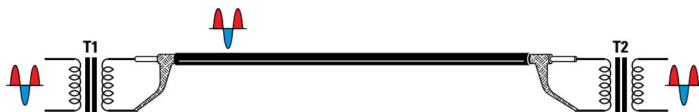
Fig.2 Se si utilizza un cavetto schermato per trasferire un segnale BF da una Sorgente (vedi T1) verso l'ingresso di uno stadio preamplificatore (vedi T2), qualsiasi ronzio o disturbo captato dalla calza di schermo giungerà sul primario del trasformatore T2 assieme al segnale BF, che scorre sia nel filo interno sia nella calza di schermo.
