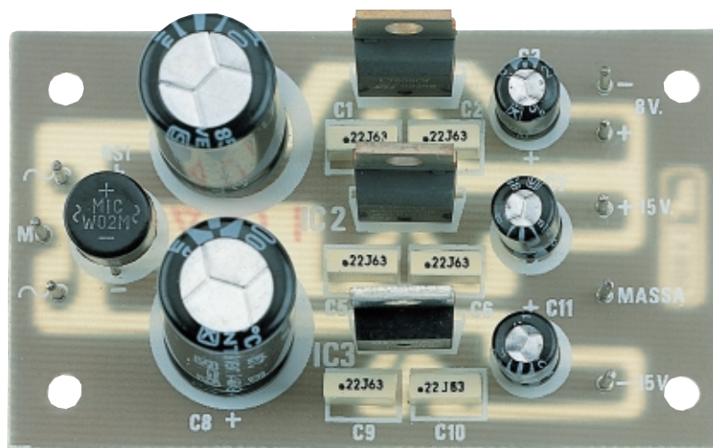
Fig.16 Foto dello stadio di alimentazione. Quando montate i tre integrati stabilizzatori, prestate particolare attenzione a non confondere le loro sigle, perché ognuno di loro stabilizza una particolare tensione; inoltre rivolgete verso l'alto le loro alette metalliche.
