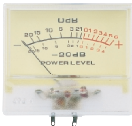
Fig.21 Lo strumentino Vu-Meter posto sul pannello frontale dell'amplificatore finale serve per visualizzare il livello del segnale BF che giunge sull'altoparlante.
