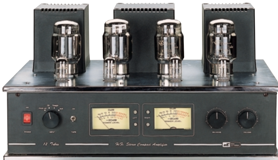
Fig.29 Gli amplificatori a valvola possiedono un fascino tutto particolare proprio per i grossi bulbi di vetro delle valvole che emettono dai loro filamenti una debole luce rossastra. NOTA: non toccate mai con le mani il vetro delle valvole perché scotta.
