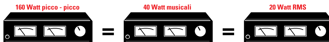
Fig.9 Tre amplificatori che erogano la stessa potenza sonora possono essere indifferentemente dichiarati da 160 watt picco/picco oppure da 40 watt musicali o da 20 watt RMS, vale a dire efficaci. Per calcolare i watt picco/picco si utilizza il valore dei volt picco/picco (vedi fig.6), per calcolare i watt musicali si utilizza il valore dei volt di picco (vedi fig.7) e per calcolare i watt RMS si utilizza il valore dei volt efficaci (vedi fig.8).
