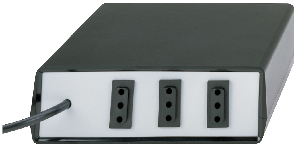
Fig.4 Sul pannello posteriore del mobile, che vi forniamo già forato, vanno montate le prese femmina che utilizzerete per accendere in modo sequenziale le apparecchiature.
