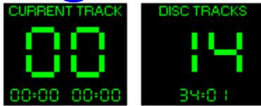
In der Digitalanzeige werden ständig Informationen über den gerade gespielten Track und die CD angezeigt. In der linken Anzeige wird der Track und die abgelaufene bzw. maximale Track-Spielzeit angezeigt. Rechts wird die Anzahl der auf der CD verfügbaren Tracks sowie die Gesamtspielzeit angezeigt.
