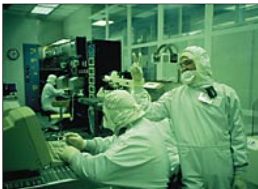
Prossessorien valmistuksessa puhtaus on viety äärimmilleen. Tuotantotilojen ilmassa saa olla korkeintaan 25 hiukkasta kuutiometrissä.
