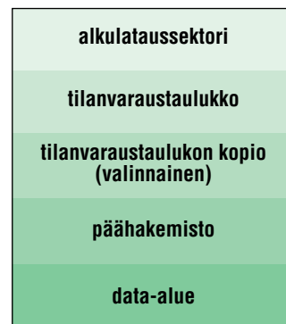
Kuva 1: VFAT-taltion looginen rakenne.
