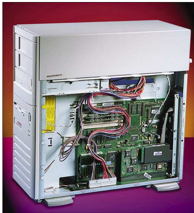
Compaqissa on hyvin suunniteltu tornikotelo. Kotelon kolme avattavaa peitelevyä voidaan avata ilman työkaluja. Yhden takana on emolevy, toiselta puolelta pääsee hyvin käsiksi korttipaikkoihin. Kotelon yläruenassa oleva osa peittää massamuistipaikat ja virtalähteen.
