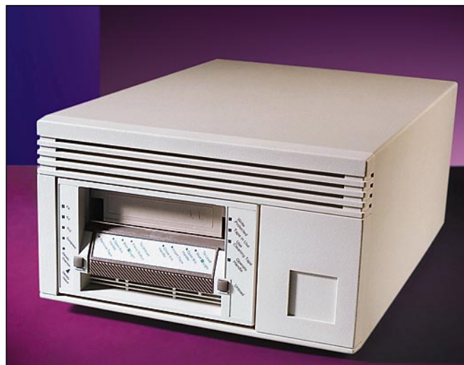
Quantum DLT2000 -nauha-asema käyttää puolen tuuman nauhoja, joiden pakattu kapasiteetti on 20 gigatavua.
