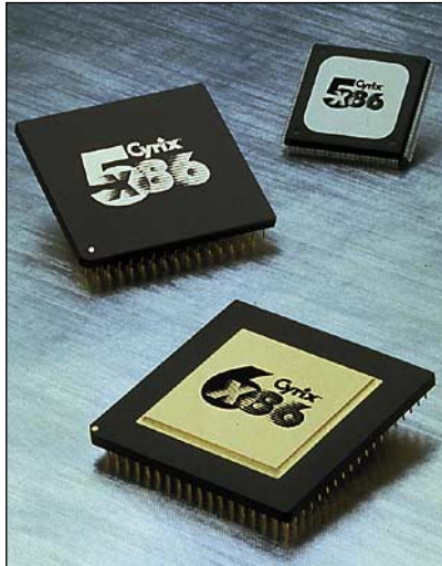
Uutuusprosessoreista mielenkiintoisin oli Cyrixin 120 megahertsin Cy6x86, jota käyttää muun muassa AST, Compaq ja Epson.
