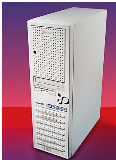
Systema 160/R on koottu varsin tyylikkääseen tornikoteloon. Kotelon yläosassa olevat kiintolevyt on suojattu yksinkertaisella lukolla.
