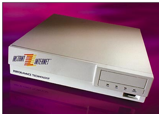
Instant Internet perustuu Netware-verkkoon kytkettävään erikoismalliin 486sx-mikrotietokoneeseen.
