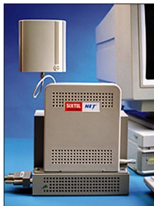
Suuntaavalla antennilla voidaan verkon kuuluvuusalueutta jatkaa vapaassa tilassa jopa kilometriin tai rakennuksen sisällä seinän läpi.
