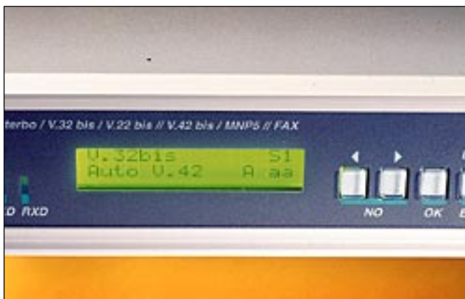
Nokia on ainoa LCD-näytöllä varustettu modeemi. Näyttö kertoo laitteen toiminnasta ja sitä käytetään myös asetusvalikoiden kaikkien laaamiseen.
