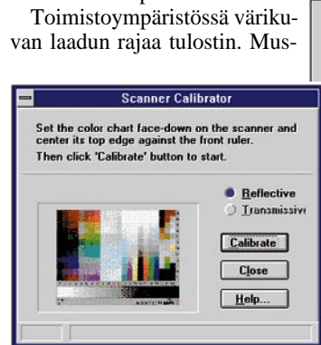
Microtek ScanMakerin kalibrointi on vertailun kattavin. Itse skanneri kalibroidaan lukemalla IT.8-testikuva. Kalibrointiohjelma vertaa saatua kuvaa testiarkin tunnettuihin väriarvoihin ja tekee tarvittavat korjaukset skanneriprofiiliin.
