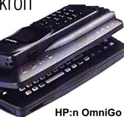
HP:n OmniGo 700-kämmentikron saa tietoliikenneominaisuudet, kun sen selkään kiinnitetään Nokian GSM-puhelin.
