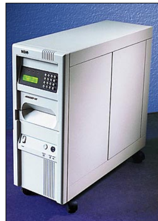
NSM:n CD-jukeboxissa on neljä levympyörittäjää. Enimmillään laitteeseen mahtuu 150 levyä.
