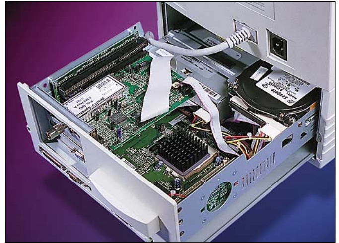
Tulipin mikro ja näyttö on rakennettu yksin kuoriin. Mikron emolevy liukuu takakautta ulos lisäkorttien tai muistin asennusta varten.
