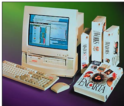
Compaq Presario CDTV 528 -mikro on varustettu multimediaominaisuuksilla ja TV-viritimellä.
