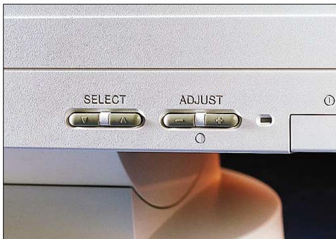
Nokian monitorissa on säätiminä vain neljä painiketta. Tämä on liian vähän, sillä kirkkauden ja kontrastinkin joutuu säätämään kuvavuorokauden ilmestyvän valikon kautta.
