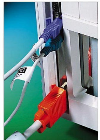
Näyttö, näppäimistö ja hiiri on helppo kytkeä oikeisiin paikkoihin, koska liittimet on merkitty eri väreillä.
