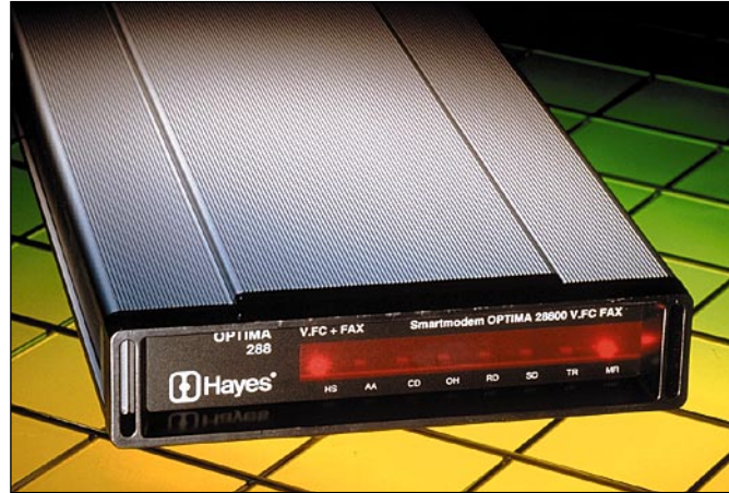
Ulkoisen modeemin merkkivaloista saattaa olla apua ongelmatilanteiden selvittämisessä.
