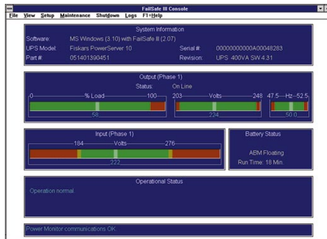
Havainnollinen hallinta-ohjelmisto kertoo oleelliset asiat UPSin tilasta. Kuvassa on Fiskarsin Failsafe III, jolla yksittäiseen PC-laitteeseen liitettyä UPS:ia voidaan tarkkailla sekä hallita.
