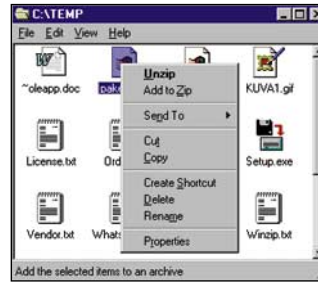
Kuva 2. Esimerkki räätälöidystä paikallisvalikosta, johon on lisätty vaihtoehto Unzip pakattujen .ZIP-tiedostojen purkamista varten.
