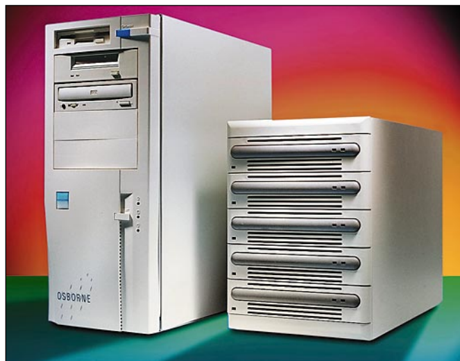
Osbornen suuremmat palvelimet kootaan kahteen koteloon, pienemmässä on levyjärjestelmä ja suuremmissa itse palvelin.
