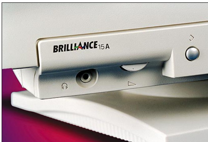
Philipsin monitorissa on kaiuttimet. Etupaneelissa on myös kuulo- keliitäntä ja äänenvoimakkuudensäädin.
