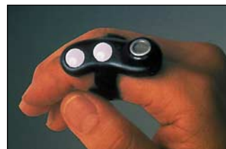
Messujen erikoinen oheislaite oli Kantek Incin valmistama langaton 3D-hiiri nimeltään Ring-Mouse.
