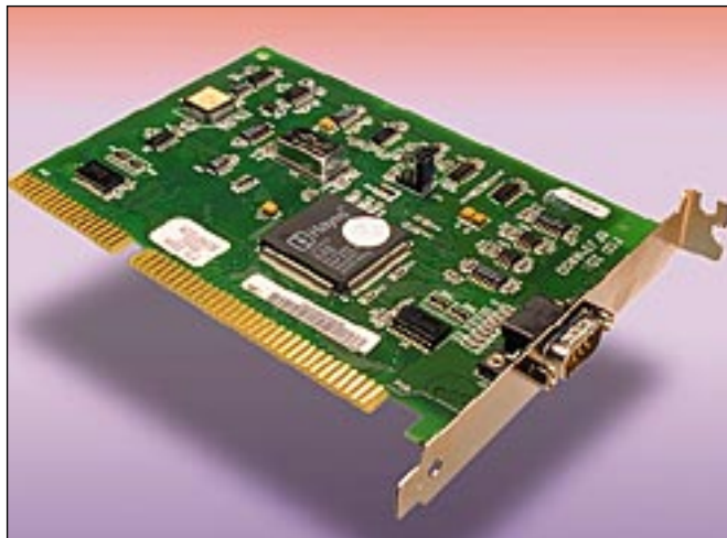
28800 bps:n tiedonsiirtonopeus vaatii suorituskykyisen I/O-kortin. Joissain modeemeissa tulee kunnollinen sarjaliikennekortti mukana, toisissa se on lisävaruste. Kuvassa Hayesin kortti.
