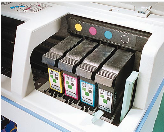
DeskJet 1600C käyttää jokaiselle musteelle erillistä säiliötä. Yhden värin loppuminen ei siten johda jokaisen värin uusimiseen, mikä säästää kustannuksia.
