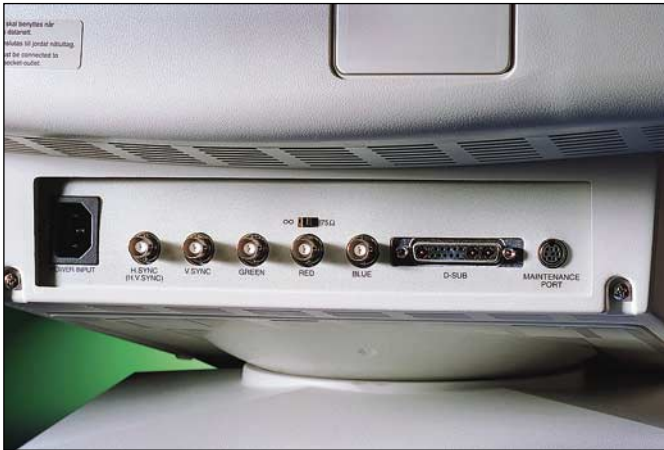
Suuret tarkkuudet vaativat suuria taajuuksia. Ilman häiriöitä signaalia kulkee vain koaksiaaliliittimissä. Eizon monitorissa on myös pienempi liitin, joka sisältää koaksiaalikonaktit.
