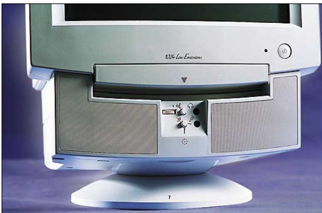
Näyttöön integroidut kaiuttimet ovat multimediamikrossa hyvä keksintö sillä se vähentää johtohässäkkää kiitettävästi. HP:n lisäksi integroidut kaiuttimet oli tarjolla Compaqilla ja Packard Bellillä.
