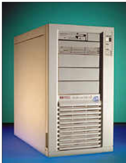
HP:n NetServer-palvelinperheen pienin, NetServer LC on pakattu pienehköön tornikoteloon. Koneensa puolesta se voidaan sijoittaa joko pöydälle tai mieluummin lattialle.
