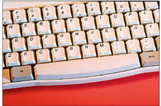
MikroMikossa on pyöristetty välilyöntinäppäin, joka lisäksi on maa-doitettu. Tällä varmistetaan, ettei käyttäjän ja näytön välille synny jännite-eroja.
