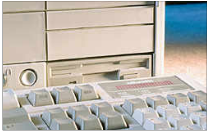
Olivettin pöytäkotelo levykeasema on liian alhaalla. Jos näppäimistö on koneen edessä, levykeasemaa ei voi käyttää.
