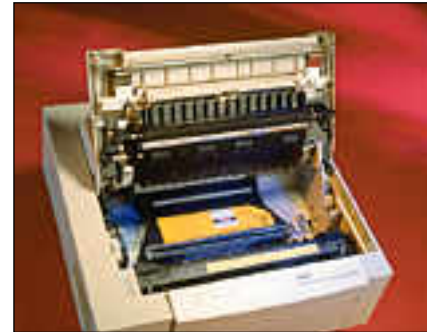
NEC:ssä on vain laseryksikkö kirjoittimen pohjalla ja paperinkuljetusmekanismi. Elektroniikka on karsittu minimiin ja kaiken laskennan tekee PC. Etuna on edullinen hinta ja haittana täydellinen sitoutuminen siihen käyttöjärjestelmään, johon valmistajalla on tarjolla toimiva ohjain.
