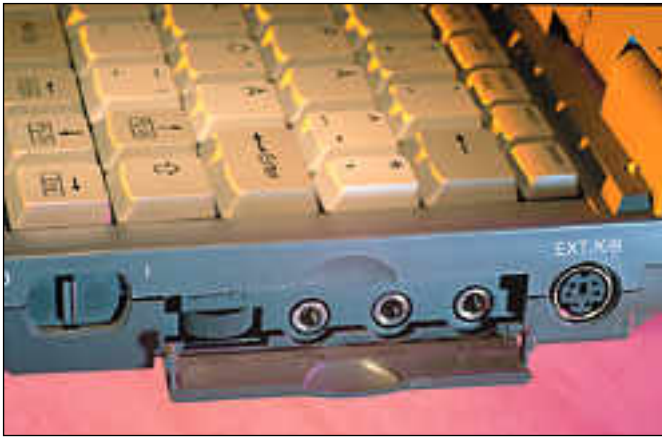
CityNotessa on sisäänrakennettu äänikortti, jonka liitännät ovat koneen oikeassa sivustassa.
