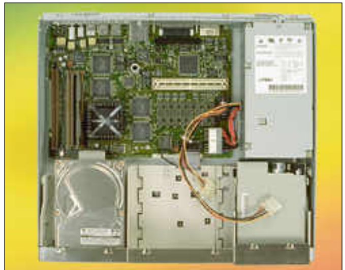
Laite on sisältä todella yksinkertaisen näköinen, mutta pieneen emolevyyn on silti mahdutettu monipuoliset toiminnot. Macintoshin normaalien sarja- ja AppleTalk-porttien lisäksi on liittänyt SCSI-laitteille, Ethernet-verkolle ja näytölle. Testikoneessa on lisäksi kiihdytetty näyttönohjain.
