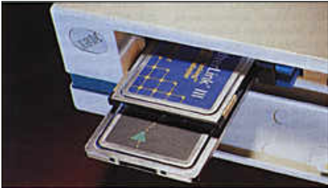
IBM:n Energy PC (PS/2 E) on ensimmäinen PCMCIA-pöytämicro. Virtaa ei tarvitse katkaista, kun kortteja lisätään ja poistetaan.
