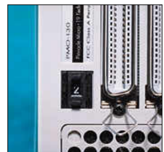
SCSI-laitenumeron valinta on helppoa, jos asemassa on napulat sitä varten. Vain Pinnaclessa oli tällainen.
