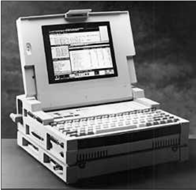
Linjakuriantalysaattorit muistuttavat yhä useammin kannettavia mikrotietokoneita, uusimmat on jo integroitu tavallisiin muistikirjamikroiin. Kuvassa HP:n yhdistetty WAN/LAN-analysaattori J2300A.
