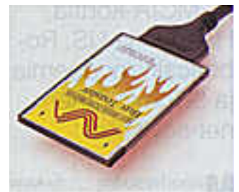
Bus Toaster -SCSI-sovittimen voi asentaa käynnissä olevaan koneeseen. Liitimestä huolimatta kortti on vain 3,3 milliiä paksu.
