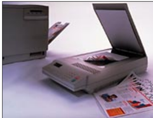
Phaser CopyStation mahdollistaa Tektronixin värilaserkirjoittimen käytön myös kopiokoneena.
