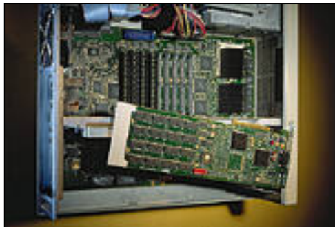
Kaksi 90 megahertsin Pentiumia ovat emolevyn takaosassa rinnatusten. PCI-väyläinen näyttöohjainkortti on Intergraphin valmistama G91, jossa on Weitekin 9100 -kiihdytinkiiri.
