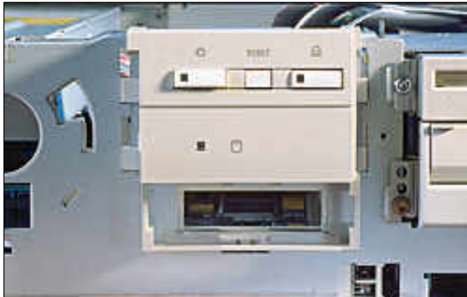
Hewlett-Packardin etuseinässä on painikkeiden alla paikka PCMCIA-sovittimelle. Oikealla alhaalla näkyy langattoman sarjaliittimen LED ja infrapunatunnistin.
