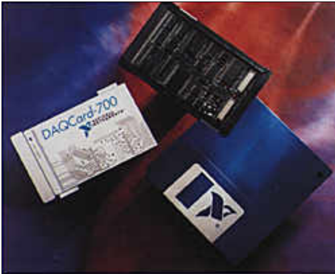
National Instrumentsin tiedonkeruukortti tulee markkinoille keväällä. Siinä on 16 analogista sisäänmenoa ja AD-muunnin, joka ottaa jopa 80000 näytettä sekunnissa. Hinta asettunee 7400 markkaan.
