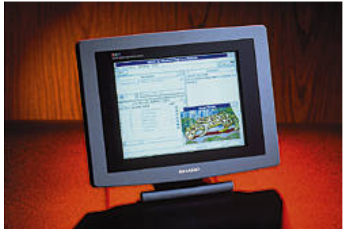
Sharpin nestekidenäytön kuvanlaatu on erinomainen, mutta 640 x 480 pisteen tarkkuus rajoittaa käyttöä. Näytössä on sisäänrakennetut kaiuttimet ja liitännät videosignaaleille.
