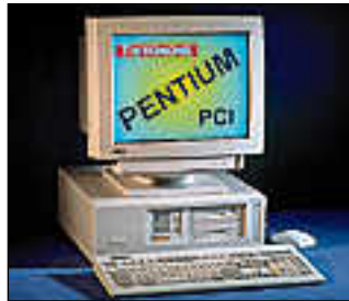
ARC on rakennettu korkeahkoon pöytäkoteloon, jossa on vapaana 5,25 ja 3,5 tuumainen massamuistipaikkaa.
