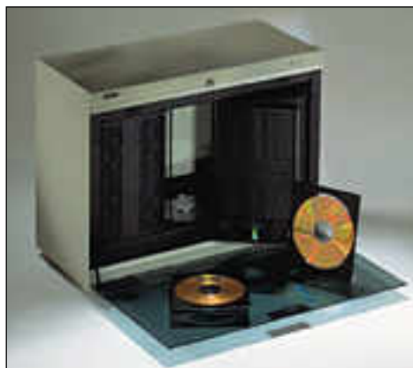
CD-jukeboxissa on kaksi 50 levyä makasiinia, joiden välissä oleva noutomekanismi hakee halutun levyn lukuyksikköön.
