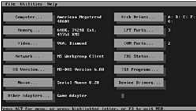
DOS 6.0:n ja Windows 3.1:n mukana toimitettava MSD-ohjelma kertoo mikrosta suurin piirtein samat tiedot kuin monet erikseen myytävät kaupalliset ohjelmat.
