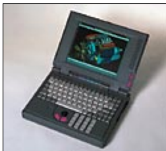
Innovacen muistikirjamikros- sa on tavallisen näppäimistön edessä numeronäppäimistö ja ohjainpallot.
