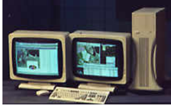
Intergraphin tehokkaimmassa TD-5-mallissa on kaksi Pentium-prosessoria. Laitteeseen saa lisäksi optiona kaksi näyttöä.
