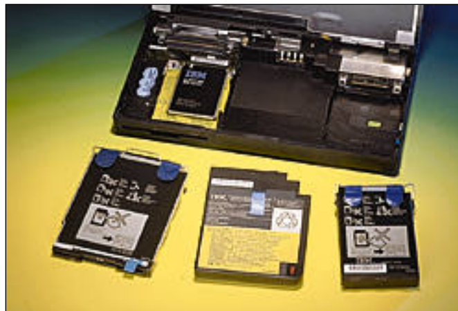
ThinkPadin saranoidun näppäimistön alta paljastuvat vaihdettava kiintolevy, akku ja levykeasema. Kiintolevyn alla on paikka lisämuistikortille.
