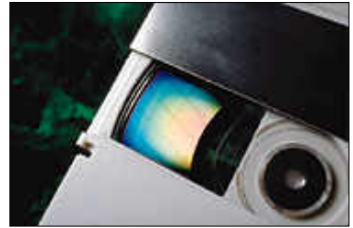
Suurempiin tallennuskapasiteetteihin päästään jakamalla levyn pinta vyöhykkeisiin, joilla sektorien pituus pysyy likimain vakiona. 230 megatavun levyke ei ole vielä saanut standardin asemaa.
