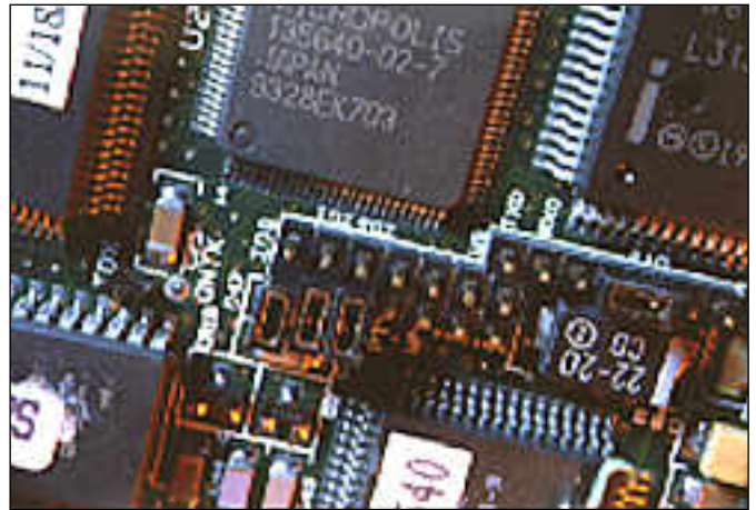
Micropoliksen SCSI-laitenumero valitaan jumbpereilla.
