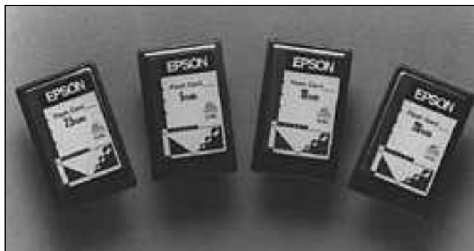
Muistikortteja voi käyttää joko muistinlaajennuksena tai kiintolevyn tapaan. PCMCIA 2.0 standardissa on määritelty XIP-toiminta (eXecute In Place), jonka ansiosta korttiin tallennettuja ohjelmia voi ajaa kortilla, siirtämättä niitä kannettavan omaan muistiin. Epsonin kortteja ei tuoda maahan.
