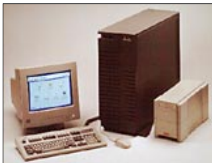
PC Server 500 -laitteen väylä on IBM:n perinteinen mikrokanava.
