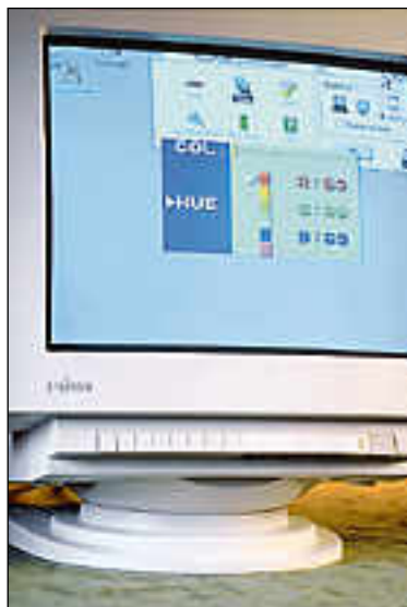
Unisisyn valikko saadaan esiin painamalla selkein kuvin merkittyjä painikkeita. Valikossa säädettävä suure näkyy sekä numeroarvona että palkkiasteikolla. Kirkkaus ja kontrasti säädetään tavanomaisilla säätöpyörillä. Helppo ja nopea säädettävä.
