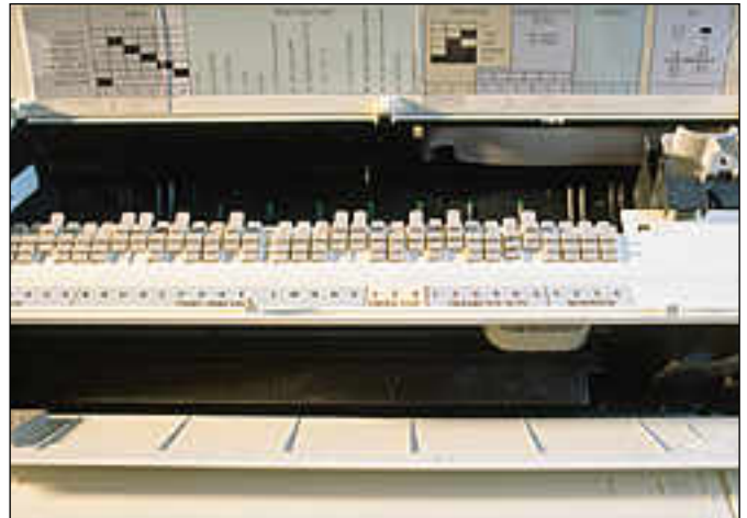
Olivetin koneistolla toimivat Citizen, DEC, Seikosha ja Olivetti käyttävät oletusasetusten määrittämiseen näppäriä muovikytkimiä, jotka korvaavat pienet ja hankalat DIP-kytkimet. Optinen anturi käy lukemassa asetukset kirjoittimen käynnistyksen yhteydessä. Muovikytkinten käyttö on helppoa, sillä niiden toiminta on selitetty selkeästi.
