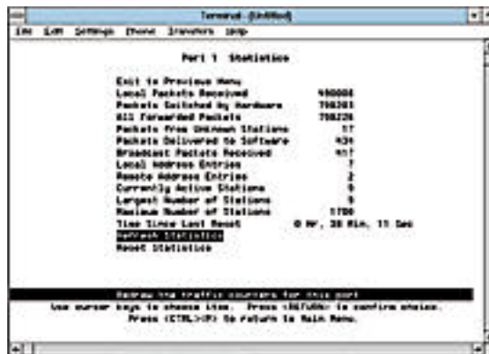
HP LAN Switchin keräämiä tilastotietoja pääsee katselemaan sarjaporttiin kytkettävällä päätelä.
