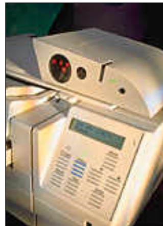
Ricohin tulostimessa on liitäntä faksimodeemille ja se toimii itsenäisenä vastaanottavana faksina. Tulostinohjaimesta voidaan valita tulostuuko paperi omasta kirjoittimesta vai lähteekö se faksina maailmalle.
