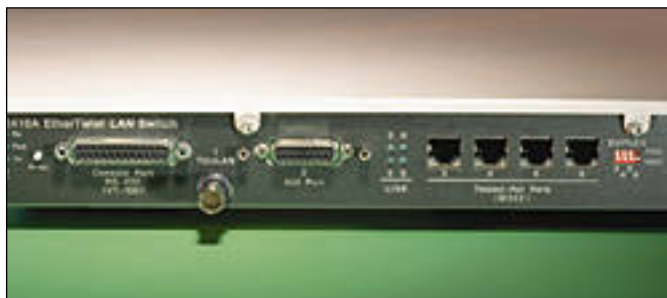
Hewlett-Packardin EtherTwist LAN Switchissä on yksi AUI- ja yksi ohut-Ethernet-liitäntä sekä neljä 10Base-T-porttia.
