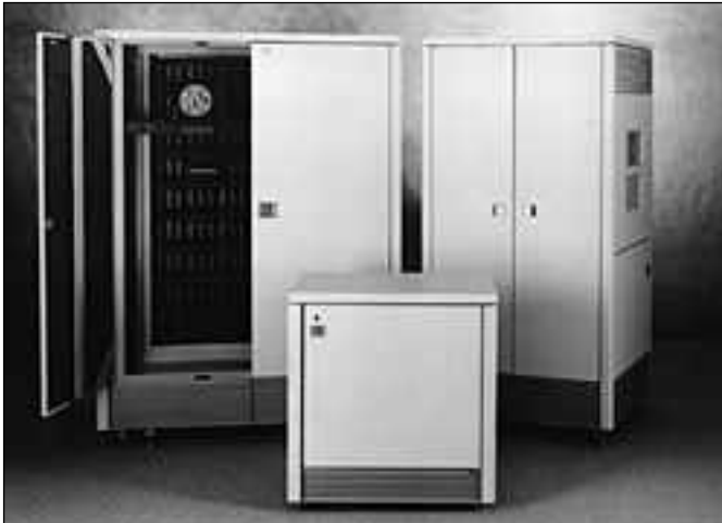
Computer Upgrade Corporation kokoaa "jukeboxin" tilaajan valitsemista osista. Suurimman kapasiteetti on 1,3 teratavua ja siinä on tuhat 5,25 tuumaista MO-levyä ja 16 asemaa. Hinta on 300 000 dollaria.
