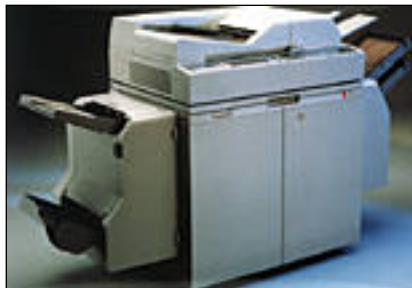
Kodakin uusi kopiokone rakentuu itse asiassa skannerista, tulostimesta ja niistä ohjaavasta tietokoneesta.
