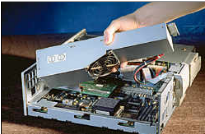
Hewlett-Packard on ratkaissut tuuletuksen elegantilla tavalla. Pienessä kotelossa tyhjäksi jäävä tila on käytetty virtalähteelle. Tuuletin puhaltaa suoraan prosessorin päälle.
