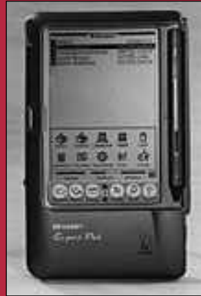
Sharp ja Newton ovat perustaltaan sama laite, mutta Sharpin mekaniikka on parempi. Kynä pysyy paremmin telineessään ja herkästi naarmuuntuvan näytön suojana on kansi.
