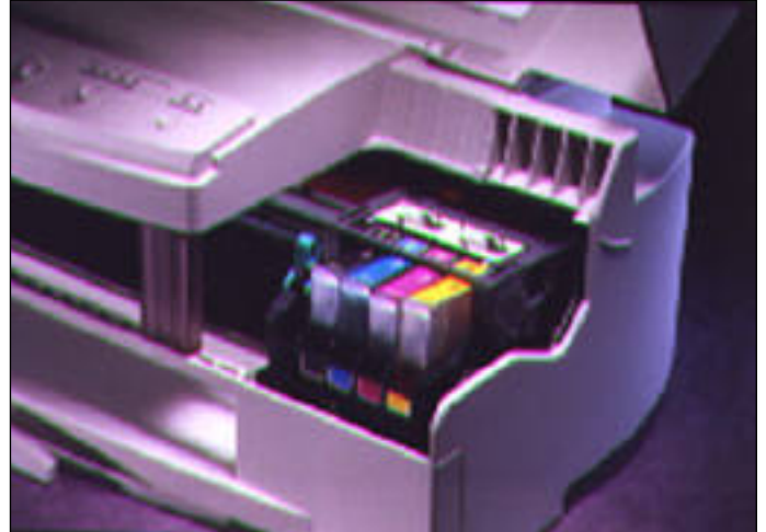
Kirjoituspää ja mustesäiliöt ovat erillisen kannen alla Canon BJC-600:ssa. Sinisävyisiin piirtoheitinkalvoihin ihastuneen ei tarvitse vaihtaa kaikkia värejä sinisen loputtua.
