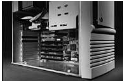
MSI:n emolevyllä on viisi ISA- ja neljä PCI-liitintä. Keskeinen korttipaikka toimii joko ISA- tai PCI-korttipaikkana.
