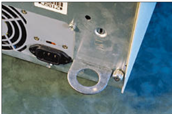
Eräs tietosuojaa lisäävä ominaisuus on lukitussimukka, joka avulla palvelin voidaan lukita paikalleen. Dellin lukitussilmukka mahdollistaa erillisen vaijerilukon käyttämisen.
