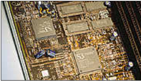
ValuePoint P -sarjan koneissa on S3:n uusi 64-bittinen 864-kiihdytinpää, jonka seurana on S3:n ensimmäinen itse valmistama D/A-muunninpää (RAM-DAC).
