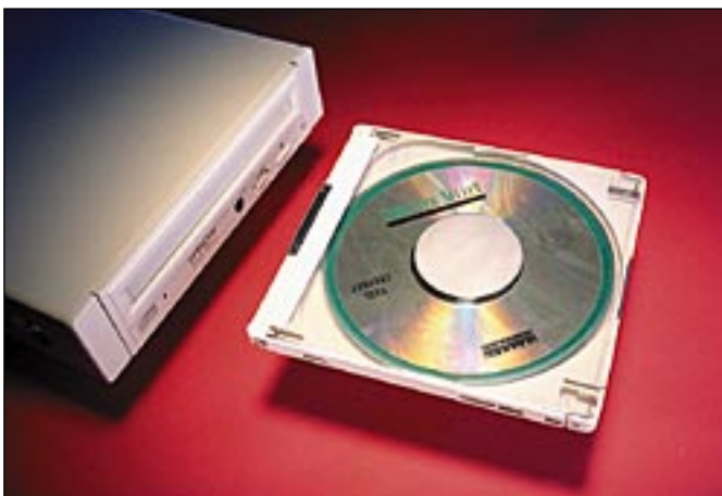
Caddy eli levykotelo suojaa CD-levyä, mutta maksaa useita kympejä. Niitä harvemmin tulee ostettua joka sovellukselle.
