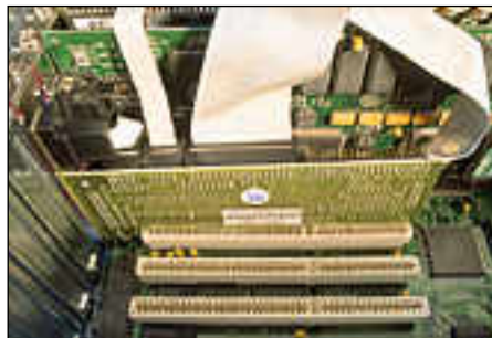
Rahtikäsitteily ja epätarkka koteloiden valmistus voivat johtaa ikäviin yllätyksiin. Kun monitorikortti on lähes irti liittimestään, ei ole toivottakaan mikron käynnistymisestä. Samassa koneessa oli vielä yksi virtakytkimen liitin irralaan.
