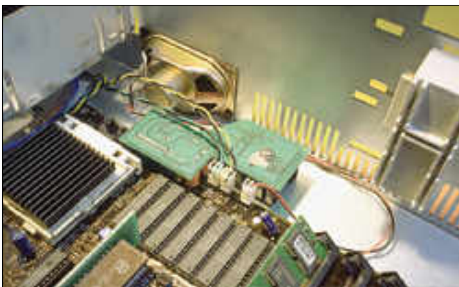
DX4 sopii piikkiensä puolesta normaaliin 486-kantaan, mutta alemman käyttöjännitteen vuoksi koneeseen joudutaan lisäämään omalla kortilla käyttöjännitteen pudotuspiirejä prosessorin yhteyteen. Matalan käyttöjännitteen ansiosta prosessori käy kellotaajuuteen verrattuna viileänä, joten jäähdyttimiksi riittää normaali jäähdytysriipa.
