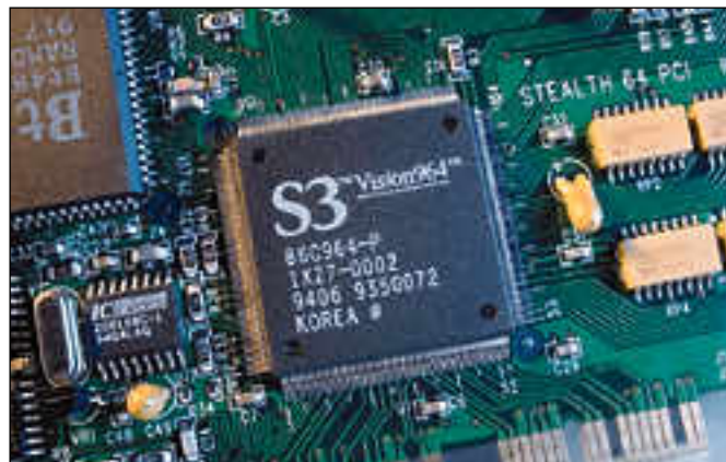
S3:n 64-bittiset kiihdytinpiirit tunnustaa mallimerkinnöistä 864 ja 964. Näistä 864 käyttää D-RAM-muistia ja nopeampi 964 V-RAM-tyyppistä muistia.
