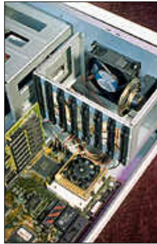
Brickin mikrossa tuuletukseen on panostettu peräti kolmella tuulettimella. Virtalähteen tuulettimen lisäksi on prosessorin päällä toinen ja kotelon etuseinässä vielä kolmas tuuletin.
