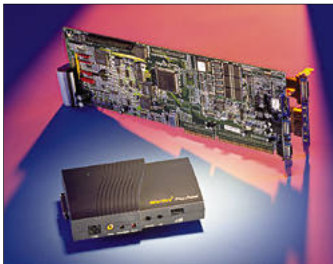
AITechin ja AVerkeyn tuotteet vastaavat toiminnoiltaan toisiaan, mutta niiden toteutustapa on erilainen. AITech audioSHOW on mikron sisään asennettava kortti, kun taas AVerKey2 on rinnakkais- ja VGA-liitäntään kytkettävä ulkoinen lisälaite.
