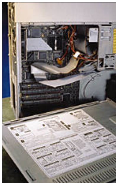
Asennusohjeilla on taipumusta häviätä, juuri kun niitä eniten tarvitaan. Vertailun laitteissa ainoastaan HP:ssä ja kuvassa olevassa Compaqissa asennusohje oli liimattuna kotelon sisäpuolelle.
