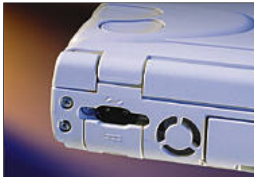
Compaqissa virtalähde on rakennettu mikron sisään, joten ohut virtajohdot liittetään suoraan mikroon. Virtajohdon liittimen vieressä näkyy pieni tuuletin.
