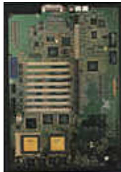
Intergraphin TD-4-mallin emolevyllä on kaksi 90 megahertsin Pentium-prosessoria.
