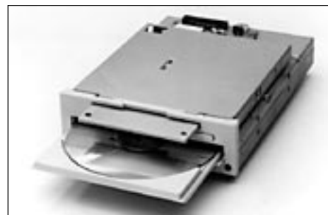
Teacin nelinkertaisella nopeudella toimivan CD-ase- man yhteydessä on korppuasema. Näin säästyy yksi laajennuspaikka.
