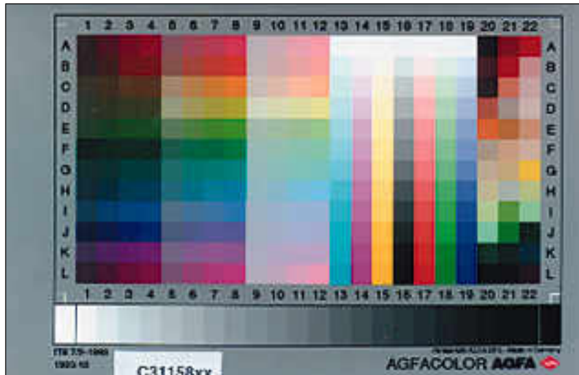
ANSI IT8-ka-librointiarkki sisältää pe-rusvärien li-säksi useita vaikeita väre-jä. Tämä arkin kuva on luetu ScanMaker IISP:llä.
