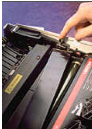
Kuvarumpu on valonarkaa materiaalia. Kirkkaassa päivänvalossa se menettää ominaisuuksiaan muutamassa minuutissa. Lexmark 4037:ssä sen suojaksi liikuu kansi, kun koneisto avataan.
