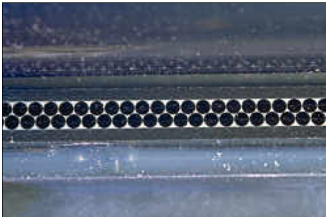
Seitsemän vertailluista tulostimista eivät ole lasereita, vaan LED-tulostimia. Niissä kuvarumpua valotetaan laserin sijaan valodiodeilla, joita on paperinlevyisessä palkissa kahdessa rivissä.
