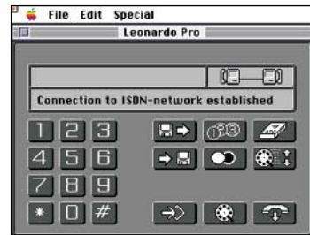
Leonardo Pron tiedostonsiirto on kuin putkiposti: ohjelmalle kerrotaan vastaanottaja ja tiedostot, minkä jälkeen ohjelma hoitaa siirron. Vastaanottajan vastuulle jää huomata tiedoston saapuminen. Ajatus on, että kaikilla on sama ohjelma jossain koneessa odottamassa tiedostonsiirtoa.
