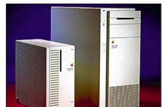
Motorolan 68040-prosessoriin perustuvat Macintoshit julkistettiin alkuvuodesta 1991. Quadra 700 ja Quadra 900 ovat muuten samanlaisia (040, 25 MHz), mutta 900:aan saa enemmän laajennuskortteja ja keskusmuistia.
