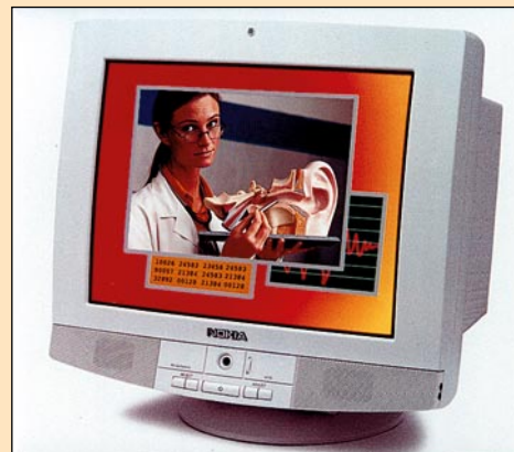
Nokian uudessa 21-tuumaisessa näyttössä on sisäänrakennettu myös videokamera ja stereokaiuttimet.
