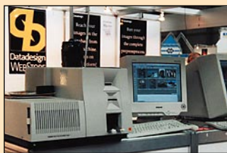
Kodakin uusi robotiskanneri oli esillä norjalaisen Interfoto AS:n osastolla. Laite antaa esikatselukuvat vajaan minuutissa laitteeseen syötetystä filmirullasta.
