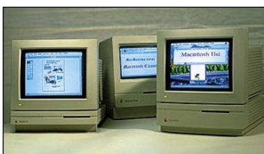
Macintosh LC, Macintosh Classic ja Macintosh IIfx julkistettiin vuoden 1990 syksyllä. Classic vastaa teholtaan Macintosh Plusia. LC on tuplasti tätä nopeampi, kun IIfx on noin kaksi-kolme kertaa Classicia tehokkaampi. IIfx:hin saa yhden NuBus-kortin, jos laitteensa on erillinen sovitinkortti.
