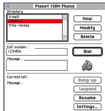
Planet tukee Applen Telephony Manageria. Planetin analogiporttiin voi kytkeä puhelimen, mutta siitä käytetään vain luuria. Näppäimet ja soittokelo ovat Macintoshissa. Tekniikan puolesta puhelimen hälyttäessä voisi nimen lisäksi ruudulle tulla automaattisesti asiakastietokannasta kaikki soittajasta olevat tiedot.
