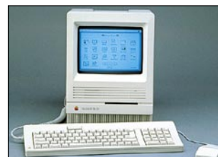
Macintosh SE/30 on kompaktimalli, jossa on Macintosh IIfx-mallin tekniikka. Se on noin kaksi-kolme kertaa nopeampi kuin pelkkä SE tai Plus. Sen yhdeksän tuuman mustavalkonäyttö on kuvanlaadultaan erinomainen.
