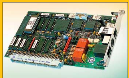
Planet on Nubus-kortti ja se tukee protokollista X.25:ä ja X.75:ä. Jollei Planetia voi käyttää sen CTB-työkälulla on Macintoshin sarjaportti yhdistettävä Planetissa olevaan sarjaporttiin, jolloin Planet toimii AT-komennoilla kuten muutkin tässä esitellyt päätelaitteet.
