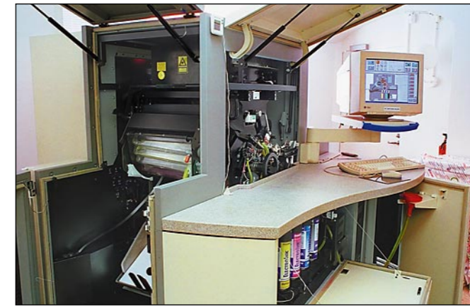
Indigo E-Print 1000 ei ole lainkaan painokoneen näköinen. Futuristisesti muotoiltu laite sopii siististi toimistotiloihin. Koneen käyttökin muistuttaa täysin tavallisia väritulostimia.
