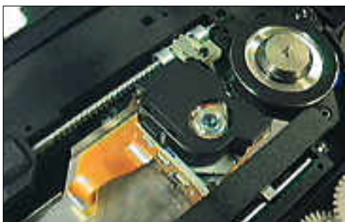
Applen molemmat vanhemmat mallit, CD 150 ja CD 300, perustuvat Sonyn valmistamaan järeään mekaniikkiin. Moottori on tukeva ja harjaton, ja lukupääkelkkaa siirretään käytännössä kulumattomalla lineaarimoottorilla. Kuva koneiston alapuolelta.
