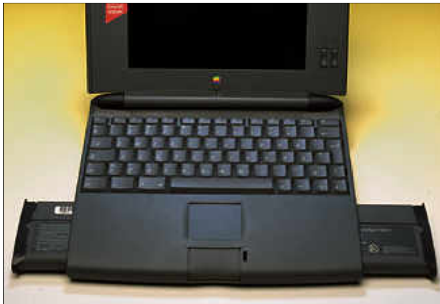
Akut on sijoitettu rannetukien sisään koneen etureunaan. Vasemman puoleinen akkukuilu toimii vaihtoehtoisesti laajennuskorttipaikka.
