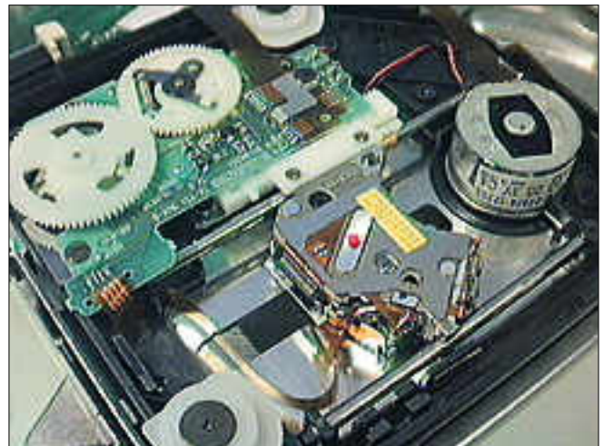
Toshiban 4101 on esimerkki halvemmasta mekaniikasta. Suurin osa koneistosta on muovia, levyn pyöritysmoottori on pienikokoinen halpa harjatomootori, ja lukupääkelkka liikkuu moottorin ja hammaspyörän ohjaamana.
