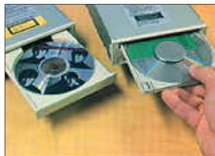
NECin edullisessa MultiSpin 2x:ssä lukupäätä siirretään pienen moottorin ja "matoruuvin" avulla. Suurin osa mekaniikasta on muovia.
