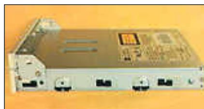
1. Ruuvinreiät ovat CD-ROM-asetien sivuissa vakioipaikoilla. Toshibaassa reikiä on aseman matalammasta rakenteesta johtuen vain kaksi sivua kohden. Normaalisti kiinnitysreikiä on neljä kummallakin sivulla.
