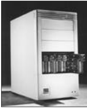
MicroArray koostuu viidestä 2,5-tuuman pystyyn asennetusta levyasemasta.
