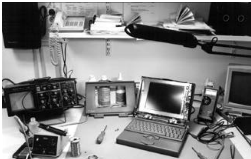
Kannettavien tavallisimmat viat liittyvät näyttöön ja ohjauspalloon. Tässä PowerBookissa on näyttövika.
