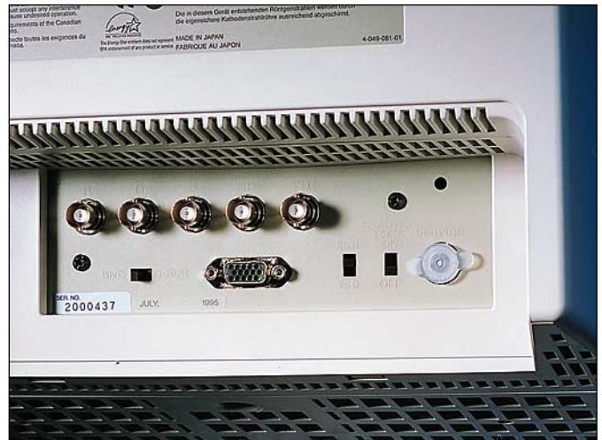
Myös Sonyn monitorissa on BNC-liittimet, jotka takaavat häiriöttömän kuvan suurellakin tarkkuudella. Kytkimellä valitaan tarvittaessa liittinten impedanssi. Monitori toimitettiin kuitenkin VGA-kaapelilla, tosin korkealaatuisella.
