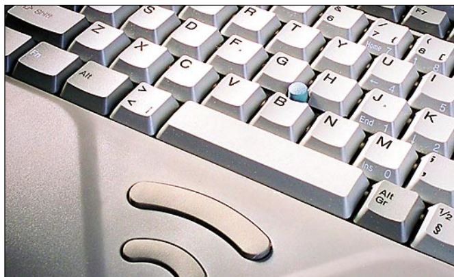
Matkamikrossa hiiri on pakko korvata jollakin ratkaisulla. Muun muassa Toshiba ja IBM ovat päätyneet kuvassa näkyvään ohjaustappiin, jota painelemalla hiiren osoitin liikkuu näytöllä.
