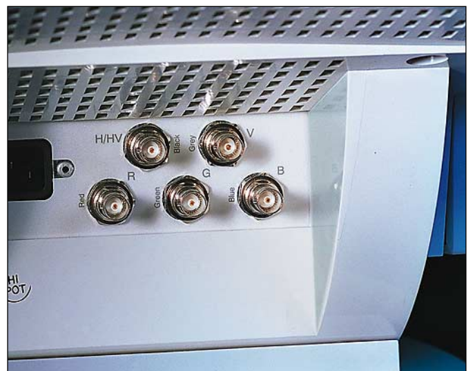
Nokia oli ainoa monitori, jossa oli ainoastaan hyvät BNC-liittimet. Kuvaa ei voi pilata huonolla kaapelilla, mutta liittimet olivat turhan lähellä toisiaan. Riskinä on, etteivät kaikki liittimet ehkä tule kunnolla lukituiksi.
