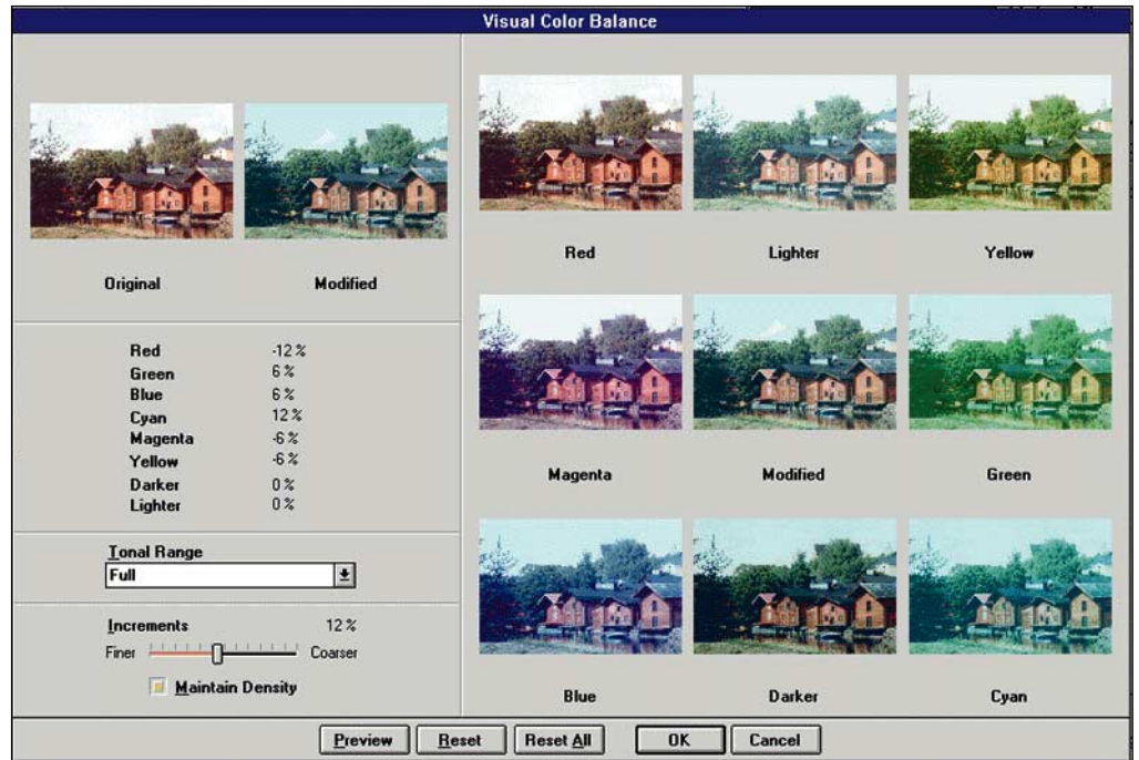
Näkeminen on helpoin tapa ymmärtää, mitä vikaa kuvan sävyissä on ja miten se korjataan. Picture Publisherin Visual Color Balance näyttää tehdyt muutokset myös prosentteina. Muutoksen voimakkuuden voi säätää portaattomasti sekä valita, muutetaanko koko sävyalueita vaiko vain osaa siitä. Photoshopissa on vastaava ikkuna nimeltä Variations.
