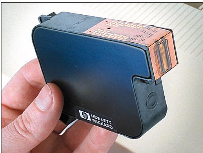
Mustesäiliö on kookas, mutta niin on suutinlevykin. Puolen tuuman matkalla on yhteensä 104 suutinta. Yhdellä pyyhkäisyllä tulostuu useita rivejä tekstiä.
