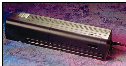
Logitech PowerPage on rinnakkaisporttiin liitettävä kuvanlukija.
