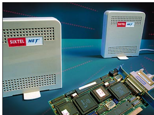
Net 3 :n antenniyksikkö on isokokoinen, eikä verkkosovittimesta ole tarjolla muistikirjamikroiin soveltuvaa PCMCIA-versiota.
