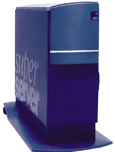
ICL:n SuperServer-palvelimiin voidaan asentaa yhdestä neljään 166 megahertsin Pentium Pro -prosessoria.
