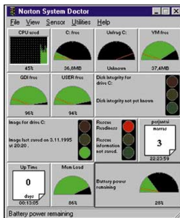
Norton System Doctor näyttää havainnollisesti monia Windowsin toimintaan liittyviä parametreja. Lähes kaikki samat tiedot on saatavissa myös Windowsilta itseltään, jos osaa käyttää Resurssimittaria ja Järjestelmäseurantaa.
