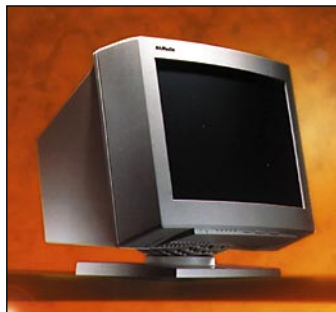
ArtMedia-näytöt perustuvat Trinitron-kuvaputkiin.
