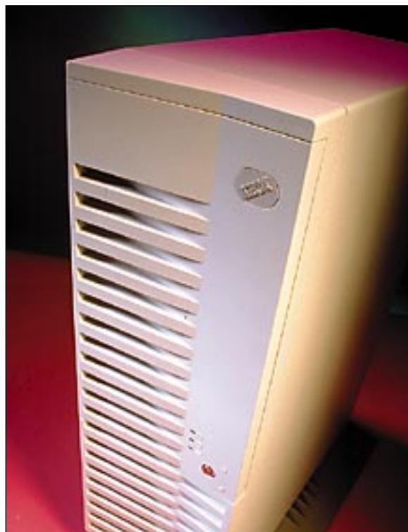
PC Serverin suuri kotelo ja kookkaat ilmanvaihtoaukot takaavat viileän käynnin ja hyvän laajennettavuuden.
