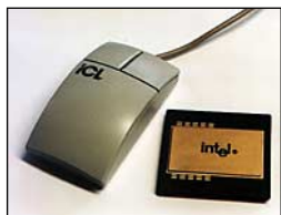
Prosessorit kasvavat myös ulkomitoiltaan. Pentium Pro on pintalaitaan jo lähes hiiren kokoinen.
