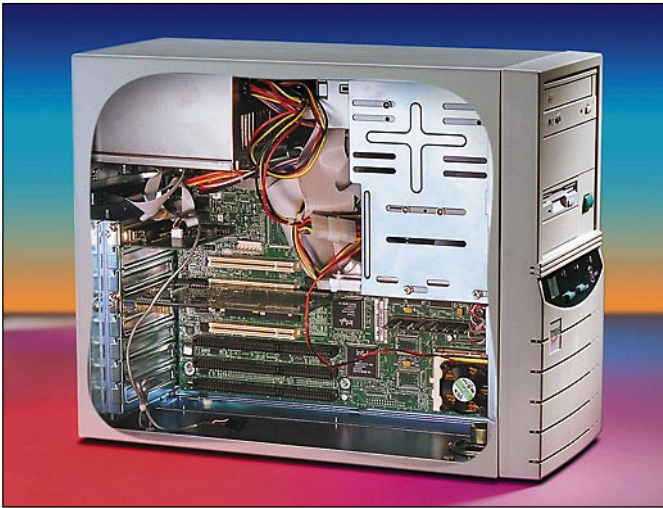
Timbre on eräs tarjolla olevista 133 megahertsin Pentium-mikroista. Sen emolevy on Intelin valmistama Endeavor, joka on hyvin pelkistetty. Selvimmin siitä erottuu isolla jäähdytyslevyllä ja tuulettimella varustettu prosessorikanta.
