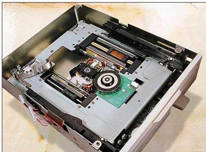
CD-ROM-aseman rakenne vaikuttaa sen saantinopeuteen ja toimintavarmuuteen. Metalliset osat kestävät kulutusta muoviosia paremmin, mutta raskaampina ne liikkuvat hitaammin.
