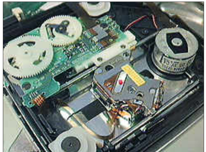
Toshiban 4101 on esimerkki halvemmasta mekaniikasta. Suurin osa koneistosta on muovia, levyn pyöritysmoottori on pienikokoinen halpa harjamoottori, ja lukupääkelkka liikkuu moottorin ja hammaspyörän ohjaamana.
