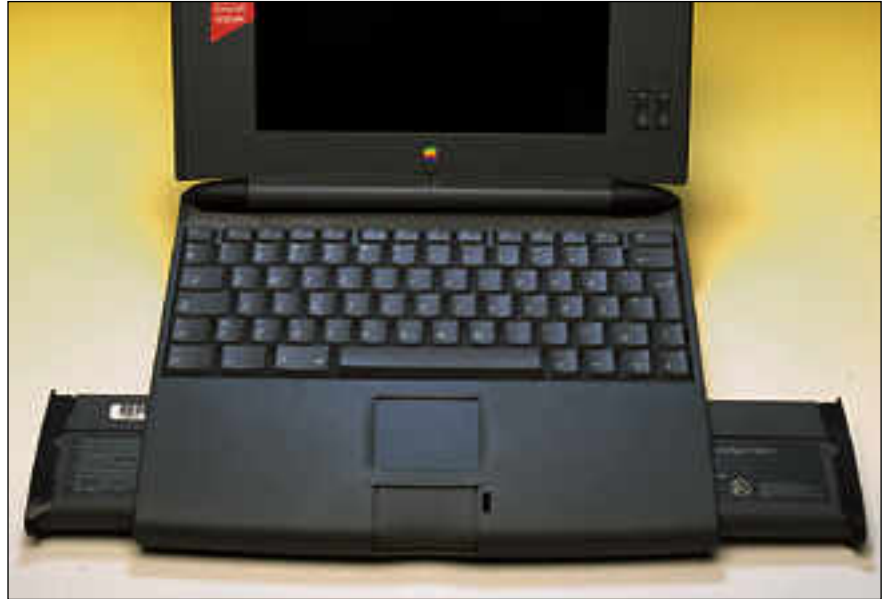
Akut on sijoitettu rannetukien sisään koneen etureunaan. Vasemman puoleinen akkukäyttö toimii vaihtoehtoisesti laajennuskorttipaikka.
