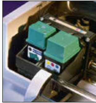
HP 560C:ssä on kaksi mustesäiliötä. Toisessa on musta väri ja toisessa kolme muuta väriä (CMY, syaani, magenta, keltainen). Kun kolmen värin säiliöstä yksi väri loppuu, on koko säiliö vaihdettava, vaikka muut värit eivät olisi vielä loppu.
