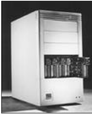
MicroArray koostuu viidestä 2,5-tuuman pystyyn asennetusta levyasemasta.
