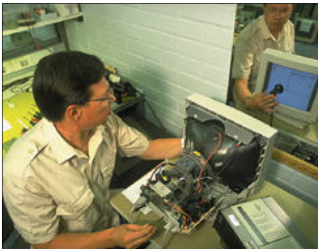
Tektorissa voidaan säätää minkä tahansa monitorin värit kohdalleen Minoltan värianalysointorin avulla. Ammattityössä ruudulla näkyvien värien oikeellisuus helpottaa työtä.
