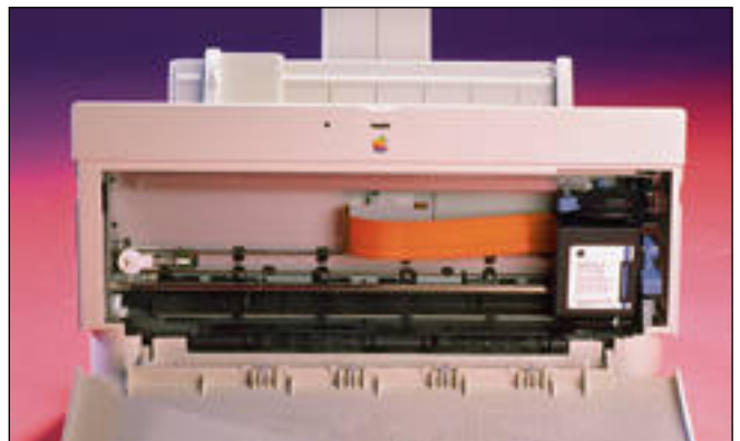
StyleWriter II:ssä paperi vedetään syöttökaukalosta melkein suoraan tulostimen läpi. Muste suihkutetaan paperille sen yläpuolella liukkuvalalla kirjoituspäällä.
