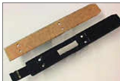
2. Macintoshin sisäiset massamuistit asennetaan laitteen kylkiin kiinnitettävillä luisteilla, joiden avulla asema liu'utetaan asennustilaan. Luistit kuuluvat sisään asennettuun asemaan vakiona. Niitä voi ostaa myös erikseen asennussarjoina. Sarjat ovat melko kalliita, ja näppärä kotinikkari voi tehdä oheisen mallin mittojen mukaan sopivan luistin myös itse.
