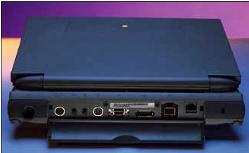
PowerBookin takaseinässä on tuhti valikoima liitäntöjä. Vasemmalta oikealle: verkkolaite, sarjaportti, ääni sisään ja ulos, ADB, Ethernet, ulkoinen näyttö, SCSI, modeemi ja lukituskaapeli. Virtakytkin on siirtynyt oikealle paikalleen näppäimistön yhteyteen.
