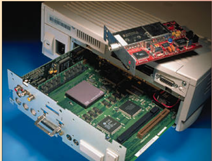
Macintosh 630:n emolevy liukuu ulos laitteen takaseinästä kahvasta vetämällä. Videokortti löytyy vasemmasta reunasta. Muut laajennuspaikat ovat muistinlaajennusta, PDS-korttia ja Ethernet-korttia varten. TV-viritin on omassa kolossaan emolevyn yläpuolella kotelon yläreunassa.
