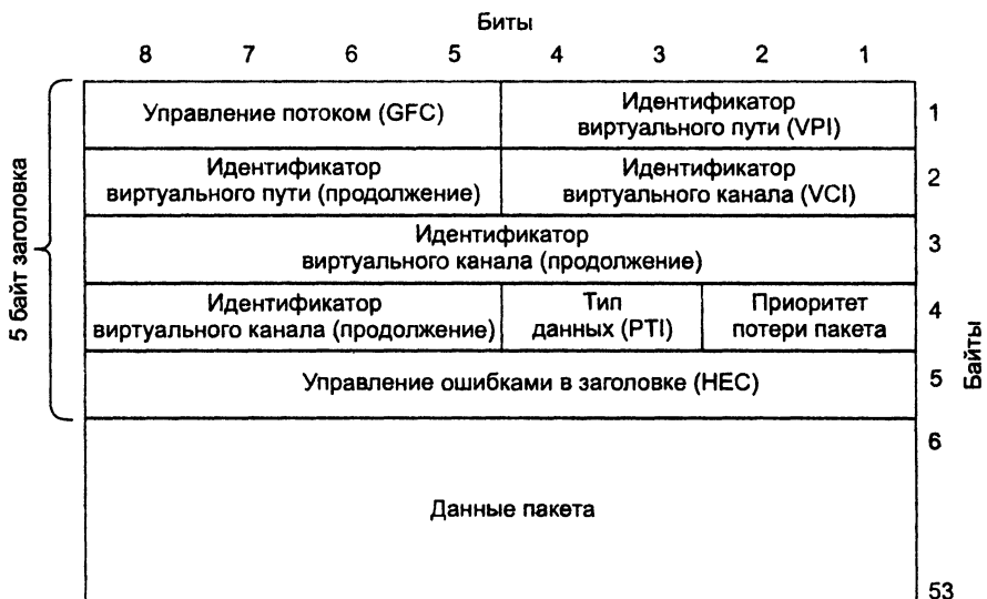
Рис. 21.11. Формат ATM-ячейки
