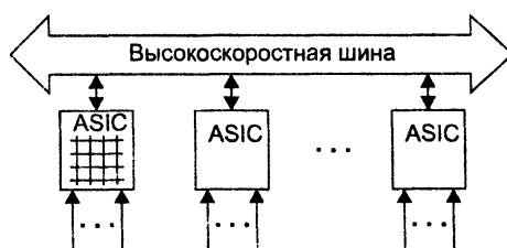
Рис. 15.18. Комбинирование архитектур коммутационной матрицы и общей шины
