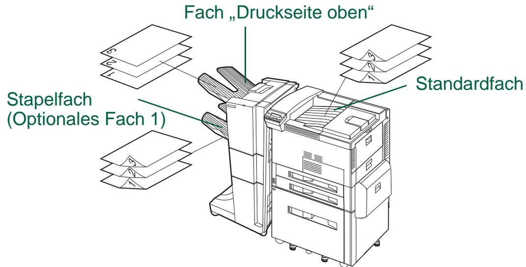
**Hinweis** Umschläge, Transparentfolien und Etiketten können NUR über das Fach „Druckseite oben“ zugeführt werden.
