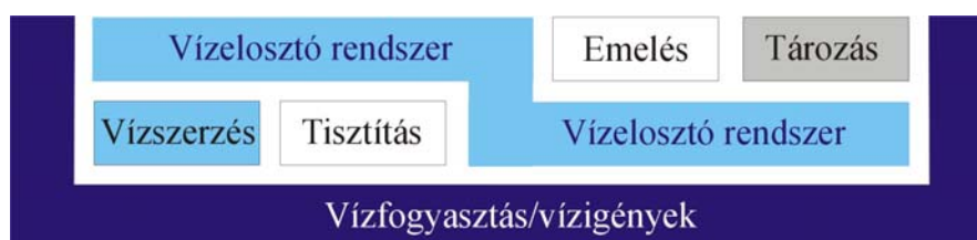
3-1. ábra Vízellátó rendszer egyes elemei
