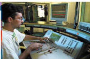
La Studer On-Air 1000 è completamente equipaggiata - come standard - da diverse interfacce di controllo macchine come "time sync", "clock sync", seriali, e due controlli per ibridi telefonici.
