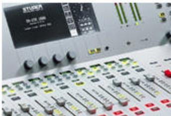
La Studer On-Air 1000 prevede 10 fader per i canali in ingresso e due fader per la sezione master, due indicatori bargraph stereo, due correlatori di fase e complete funzioni di monitor e talkback.
