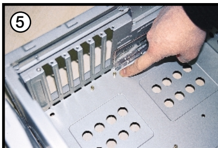
Bevor Sie das Mainboard festschrauben, sind ein paar Abstandsschrauben auf dem Boden zu befestigen.
