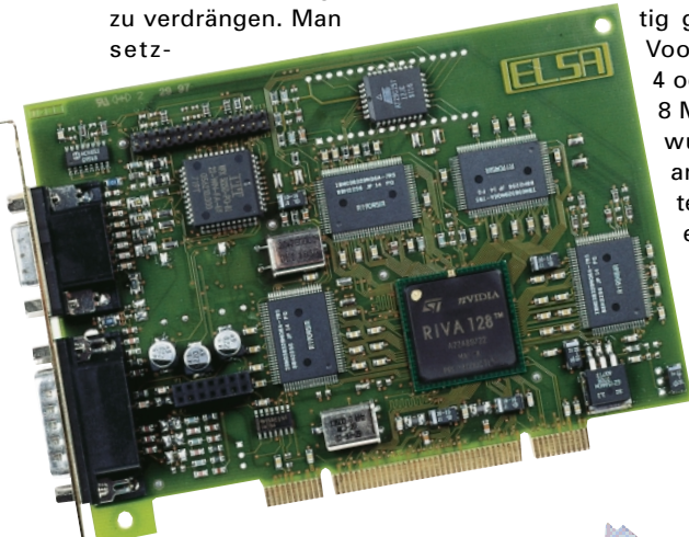
Zu den ersten akzeptablen 2D/3D-Kombikarten zählte die Elsa Victory, welche den Riva-128-Chip trug.
