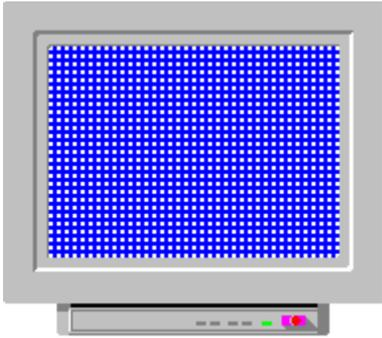
Suchen Sie nach allerlei Änderungen der Intensität, z.B. in der Form von Wellen, Bündel usw. Moire-Fehlern sind eine Funktion der Farbe. Bitte kontrollieren Sie alle Farben.
