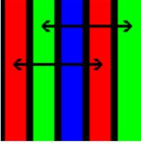
"Dot-pitch" die kurze Distanz von einen "Aperure Grill" zu einen zweiten mit dieselbe Farbe.
