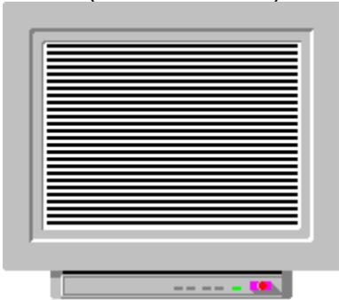
Vertikale Auflösung ist die Stückzahl von Pixels auf einer vertikalen Linie. Wenn die vertikale Auflösung 600 Pixels ist, können Sie 300 weisse und schwarze vertikale Linien (1Pixel / 1Pixel) von dem Bildschirm lesen.
