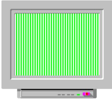
Suchen Sie nach allerlei Änderungen der Intensität, z.B. in der Form von Wellen, Bündel usw. Moire-Fehlern sind eine Funktion der Farbe. Bitte kontrollieren Sie alle Farben.
