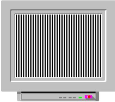
Horizontale Auflösung ist die Stückzahl von Pixels auf einer horizontalen Linie. Wenn die horizontale Auflösung 800 Pixels ist, können Sie 400 weisse und schwarze vertikale Linien (1Pixel / 1Pixel) von dem Bildschirm lesen.
