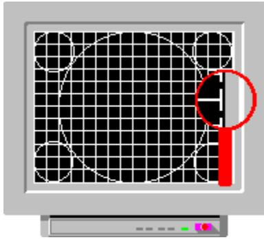
Die Grösse und die Lage des Bildes so einstellen, daß die gebrochene Linie beinahe hinter den Bildschirmrand verschwindet. Wenn diese Linie verzerrt aussieht, verwenden Sie die andere Einstellungen (für Korrektur der Trapeziumfehler, Neigung, Kissenverzerrung usw.) Der Kreis in der Mitte sollte perfekt rund sein. Das Verhältnis Höhe/Breite sollte  $4/3$  sein. Bitte korrigieren Sie die Fehlern selbe.
