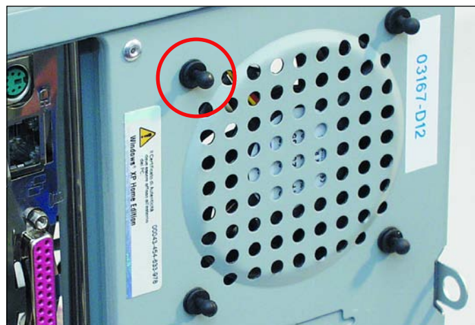
Il fissaggio della ventola di Verax con dei gommini serve a smorzare le vibrazioni, uno degli accorgimenti utilizzati sul personal computer di Bow per ridurre al minimo il rumore
