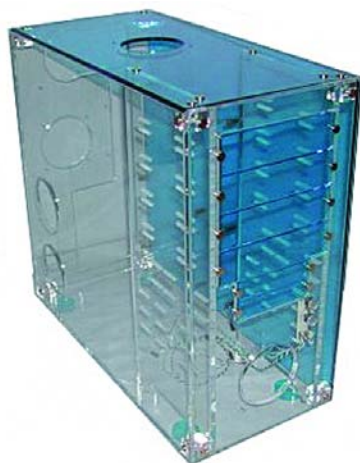
I telai trasparenti danno un bell'effetto scenico ma la robustezza è quasi nulla e la schermatura elettromagnetica inesistente
