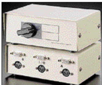
Per collegare due computer a un monitor a ingresso singolo occorre un commutatore come quello della foto
