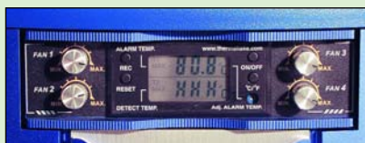
Il pannello del Thermaltake mostra la temperatura di funzionamento della CPU e quella di allarme, i quattro potenziometri regolano la velocità di rotazione delle ventole poste sul telaio
