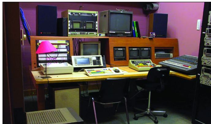
Ecco gli strumenti per una postazione di montaggio video lineare: il monitor di controllo, la centralina di montaggio, registratori VHS e Beta, una piastra per le cassette e i rack patchbay che gestiscono il collegamento tra le macchine
