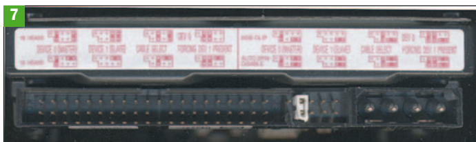
I dischi fissi di IBM richiedono diverse impostazioni dei ponticelli a seconda della presenza o meno di una seconda unità sullo stesso canale
