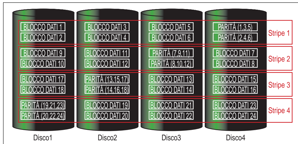
RAID 5: è la forma di RAID più usata nei server. È un array ad accesso indipendente con le informazioni di parità distribuite su tutti i dischi dell'array
