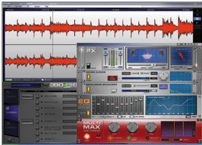
L'interfaccia di Audio Cleanic riproduce l'interfaccia grafica di veri moduli rack come il compressore a tre bande, l'equalizzatore e il riverbero
