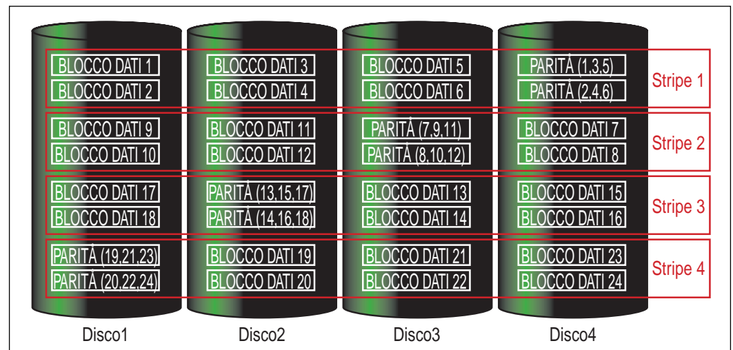
RAID 5: è la forma di RAID più usata nei server. È un array ad accesso indipendente con le informazioni di parità distribuite su tutti i dischi dell'array
