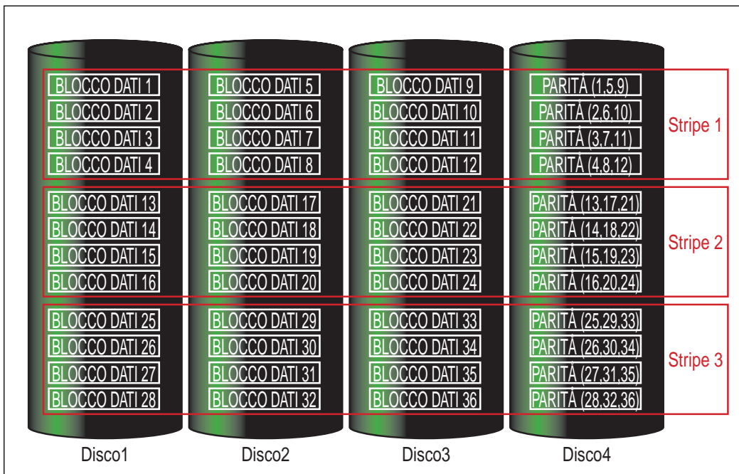
RAID 4: un array ad accesso indipendente con parità su un solo disco
