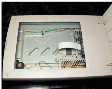
Sotto il coperchio si nota la cinghia dentata che trascina il carrello (nascosto)
