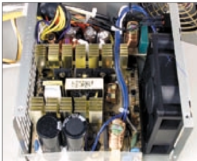
Dentro un alimentatore switching si notano solo componenti piccoli e a basso consumo: trasformatori, condensatori, diodi rettificatori, i transistor di switching e il circuito stampato con circuiti integrati e componenti discreti
