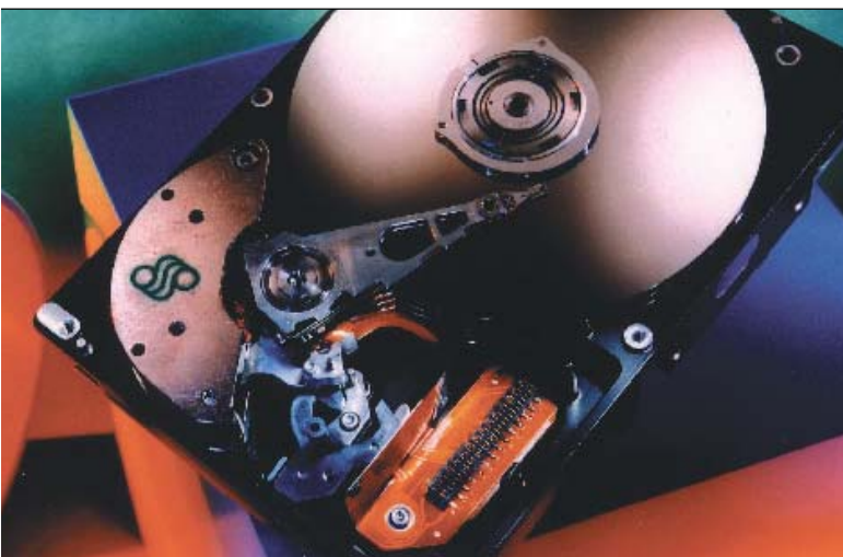
L'interno di un hard disk dà un'idea della estrema miniaturizzazione delle parti meccaniche ed elettroniche. Persino la sagoma della testina di lettura è studiata al computer per aumentare le prestazioni e l'affidabilità del disco
