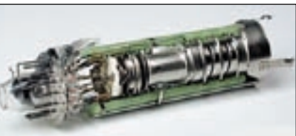
Il cannone a elettroni produce tre sottili fasci di elettroni (uno per colore primario) che vengono poi indirizzati ai tre fosfori del pixel di destinazione
