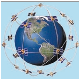
La rete GPS composta da 24 satelliti in orbita attorno alla terra
