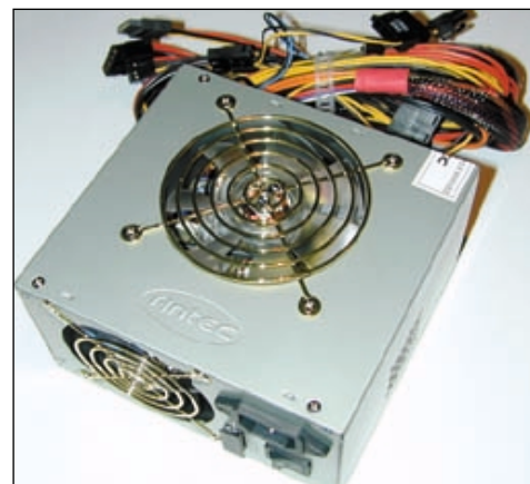
Un buon alimentatore dispone di due ventole silenziose e termocontrollate
