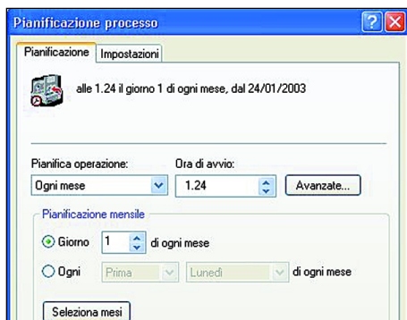
Ntbackup permette di pianificare data e ora e periodicità delle copie di backup
