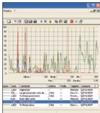
L'applicazione Prestazioni , tra gli Strumenti di amministrazione di Windows XP, permette di misurare centinaia di valori che indicano le prestazioni di ogni sottosistema del computer
