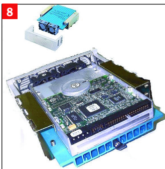
8 Per prolungare la vita degli hard disk veloci è consigliabile montare ventole o combinazioni di ventole e dissipatori
