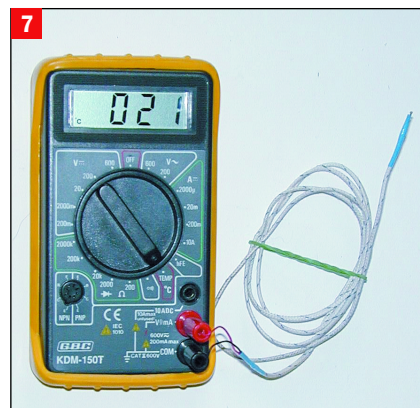
Un multimetro digitale con sonda a termocoppia per misurare le temperature
