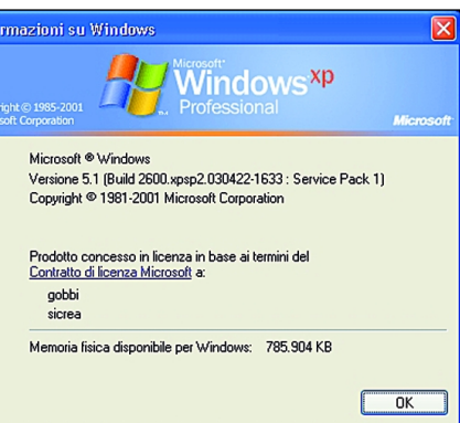
Basta eseguire winver.exe per vedere la versione di Windows e Service Pack installati
