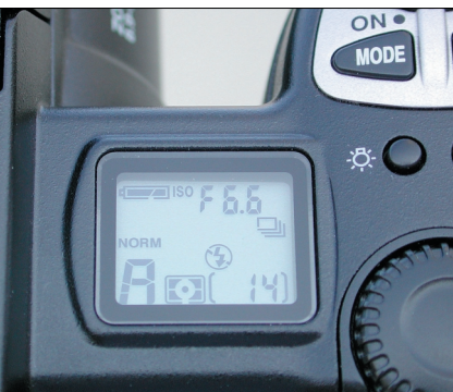
Il controllo diretto del diaframma è disponibile sulle fotocamere di fascia medio alta e viene identificato dalla lettera "A" (Apertura di diaframma) che compare sul display operativo
