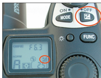
Il tasto di compensazione dell'esposizione e la relativa icona
