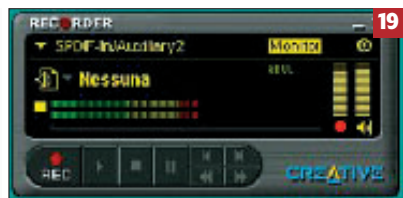
Collegando un Dat all'ingresso digitale della scheda Sound Blaster Live Platinum possiamo usare il Creative Recorder per trasferire le tracce audio sul disco rigido del nostro personal computer, senza perdita di qualità.
