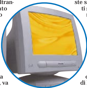
Osd è la sigla che indica la possibilità di pilotare il monitor con dei menu. Deve però essere di tipo digitale
