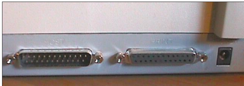
Una volta, gli scanner usavano quasi tutti un'interfaccia Scsi. Oggi sono disponibili molti modelli che sfruttano le caratteristiche della porta parallela Ecp: vanno collegati alla porta parallela del computer, ma dispongono di un'altra porta per collegarvi in cascata la stampante
