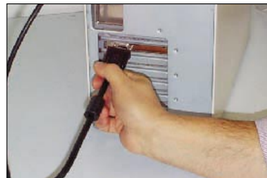
Foto 3 - Terminata l'installazione e chiuso il computer non rimane che collegare l'alimentazione. Alla scheda video si connette il cavo che arriva dal monitor. Il sistema avvertirà con una finestra di dialogo (Rilevamento nuovo hardware) del riconoscimento del nuovo hardware e verranno richiesti i driver (forniti con la scheda)
